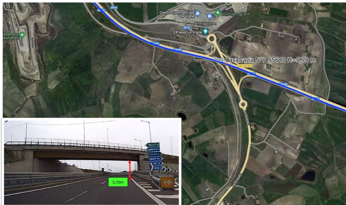
Figura 5-23 Elemento Cavalcavia SS640-7, del percorso raccomandato.
