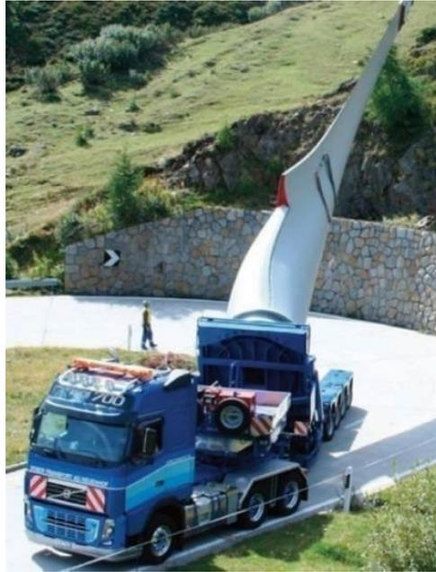
**Figura 3-3: Esempio di blade lifter**
