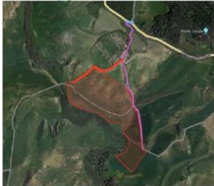
Figura 7: Area cantiere Centrale Ipogea (Viabilità 3 da adeguare in magenta, Viabilità 4 da adeguare in rosso)
