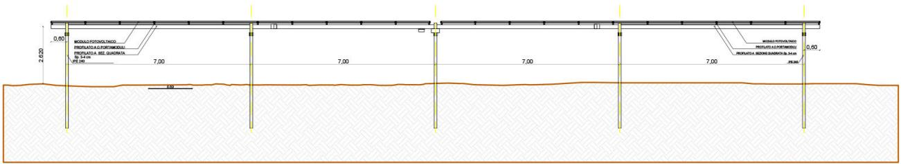
In pratica nelle prime ore della giornata e prima del tramonto i moduli non sono orientati in posizione ottimale rispetto alla direzione dei raggi solari, ma hanno un'inclinazione minore (tracciamento invertito). Con questa tecnica si ottiene una maggiore produzione energetica dell'impianto fotovoltaico, perché il beneficio associato all'annullamento dell'ombreggiamento è superiore alla mancata produzione dovuta al non perfetto allineamento dei moduli rispetto alla direzione dei raggi solari.
