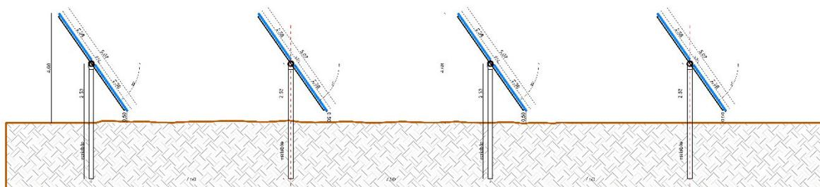
L'inseguitore solare serve ad ottimizzare la produzione elettrica dell'effetto fotovoltaico (il silicio cristallino risulta molto sensibile al grado di incidenza della luce che ne colpisce la superficie) ed utilizza la tecnica del backtracking, per evitare fenomeni di ombreggiamento a ridosso dell'alba e del tramonto.
