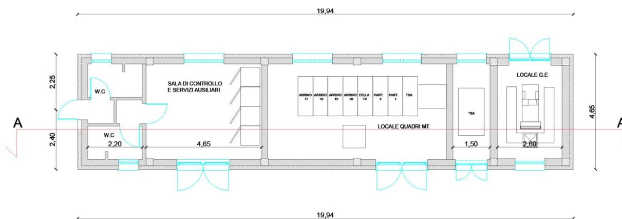
La cabina sarà dotata di servizi igienici, sala controllo, locale quadri MT, sala TSA e locale G.E. sarà inoltre dotata di impianto di illuminazione ordinario e di emergenza, forza motrice per tutti i locali, alimentati da apposito quadro BT installato in loco, nonché di accessori normalmente richiesti dalle normative vigenti (schema del quadro, cartelli comportamentali, tappeti isolanti, guanti di protezione, estintore ecc.).
