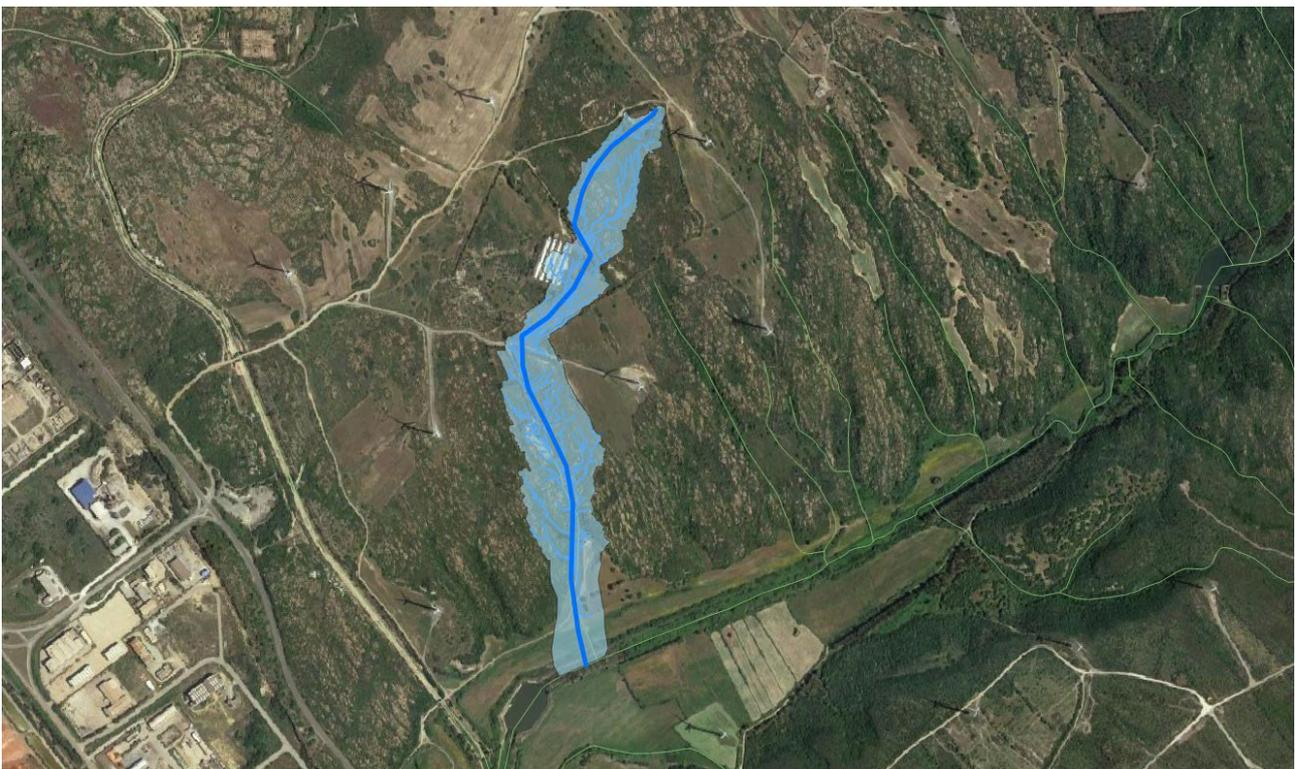
*Figura 4-1 Bacino idrografico con sezione di chiusura in corrispondenza della sezione di confluenza dell'elemento a valle*
