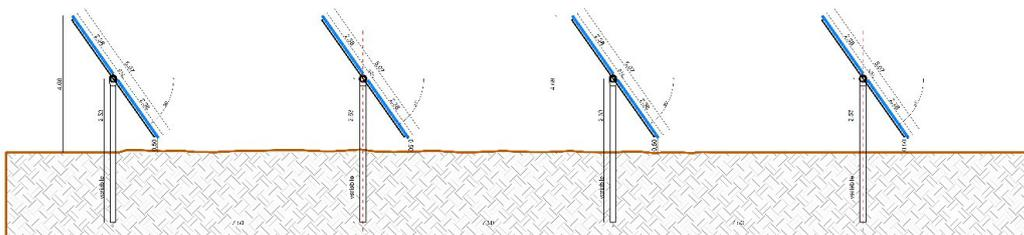
**Figura 6: Vista laterale struttura con rotazione di 55°**
