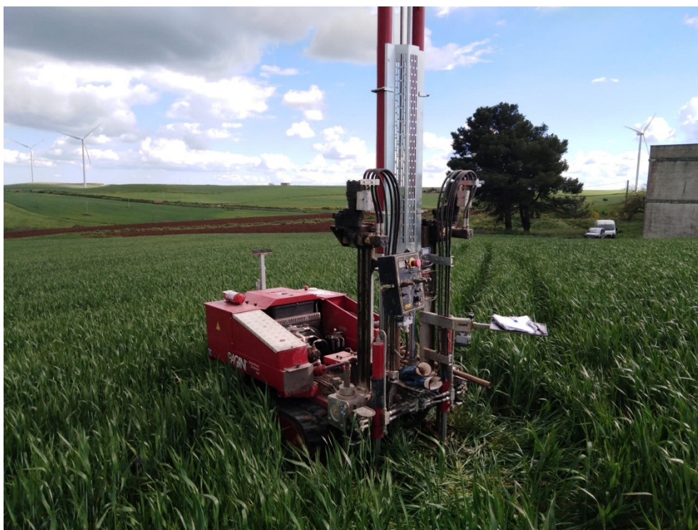
Prova Penetrometrica statica CPT 03
