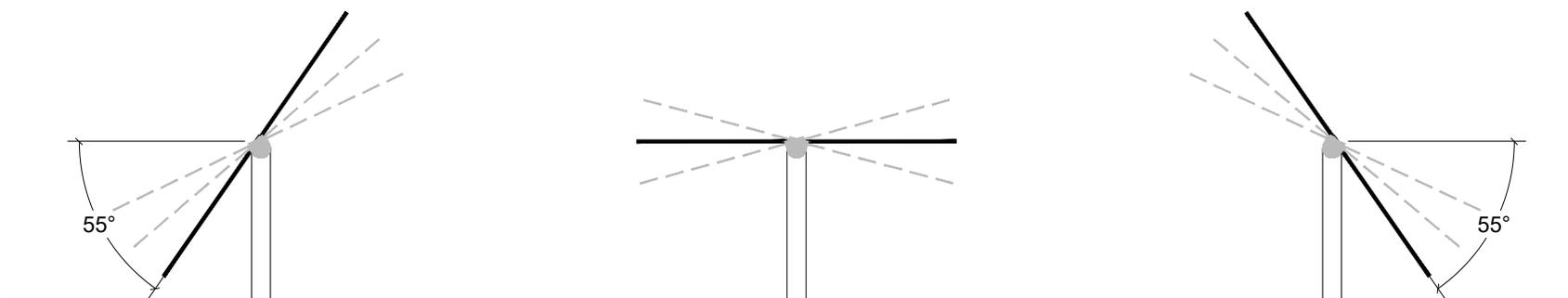
*SCHEMA DELLE STRUTTURE AD INSEGUIMENTO SOLARE DURANTE LE ORE DIURNE PER CATTURARE ENERGIA SOLARE*
