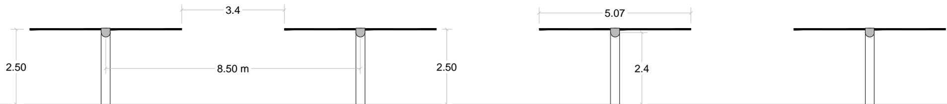
SCHEMA IN TRE STEP DELL'INSEGUIMENTO DEL TRACKER DALLA MATTINA AL MEZZOGIORNO (SOLARE) - NEL POMERIGGIO IL MOVIMENTO AVVIENE SPECULARMENTE
