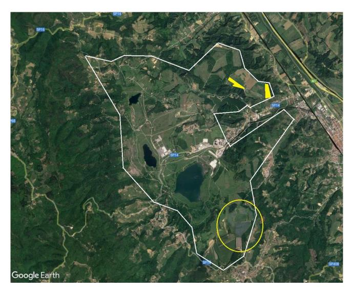
Area complessiva ex mineraria circa 3000 ettari Area oggetto di intervento impianto fotovoltaico circa 78 ettari Area di bosco oggetto di trasformazione 11.8 Ettari.
