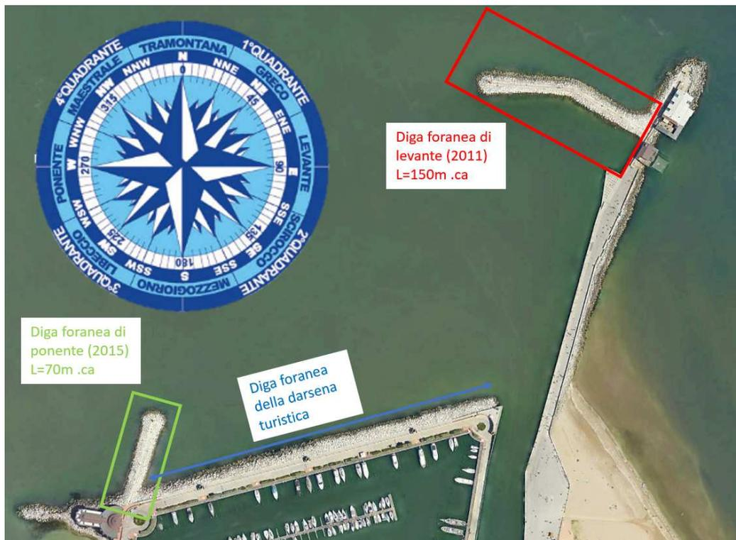
Figura 7 Configurazione attuale dell'imbocco del porto canale
