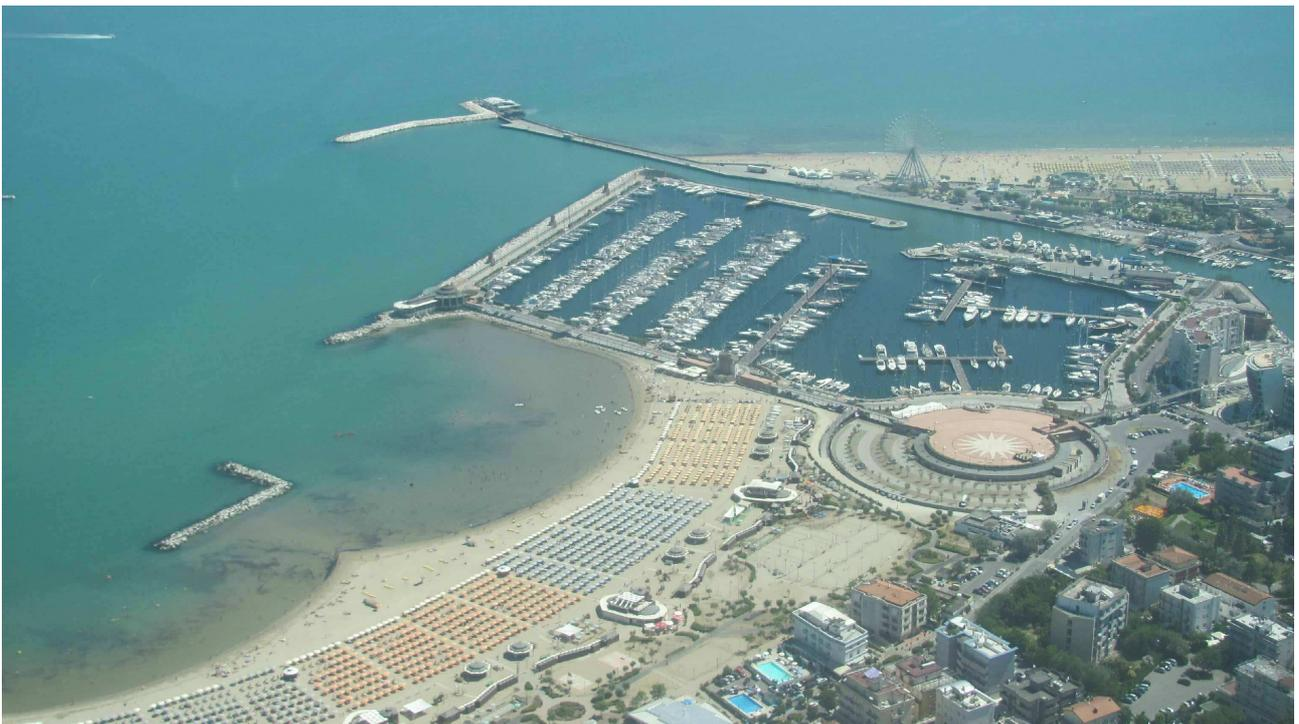
Figura 18      Fotografie panoramiche dell'area portuale di Rimini del 27 giugno 2012: in evidenza il pennello trasversale ormai completato.
