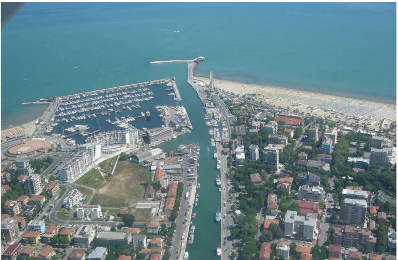
Figura 23 Fotografie da mare e da terra dell'area portuale di Rimini del 27 giugno 2012: in evidenza il pennello trasversale al molo di levante.
