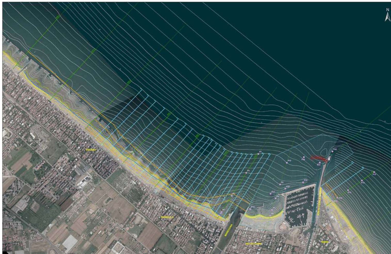
Figura 7 Carta di progetto dei rilievi topografici e batimetrici e punti di prelievo dei campioni di sedimento.
