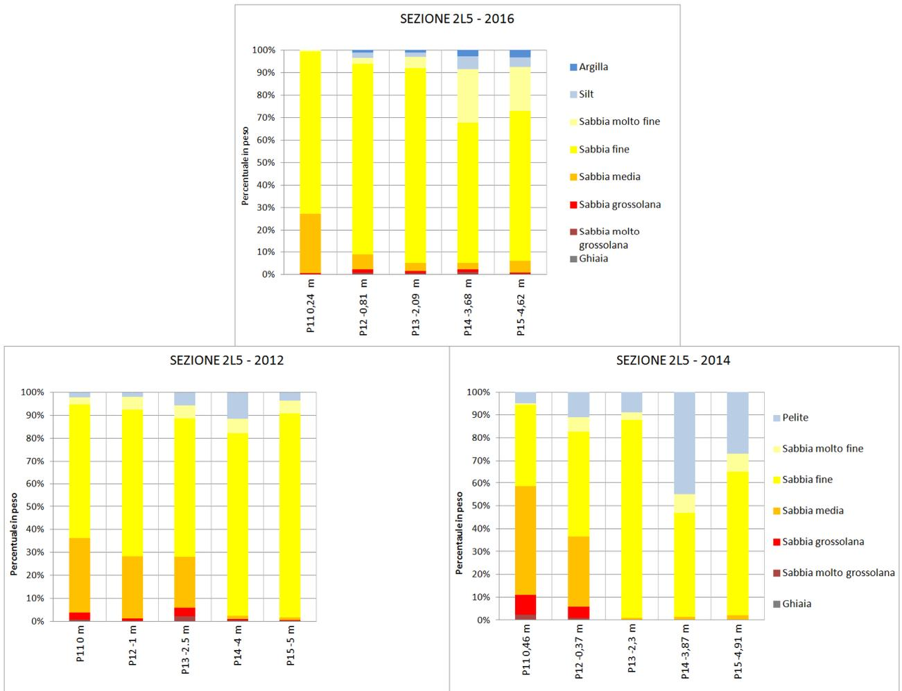
**Figura 36** Istogramma di frequenza delle analisi granulometriche effettuate nel 2012, nel 2014 e nel 2016 sui campioni prelevati a est del porto di Rimini.
