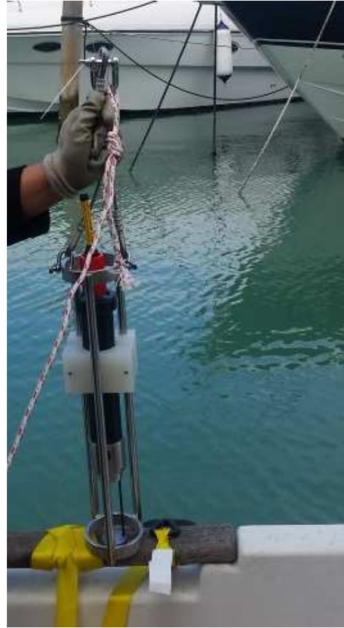
Figura 7 Trasduttore multibeam (a sinistra). Sonda per la misura del profilo di velocità del suono in acqua (a destra).
