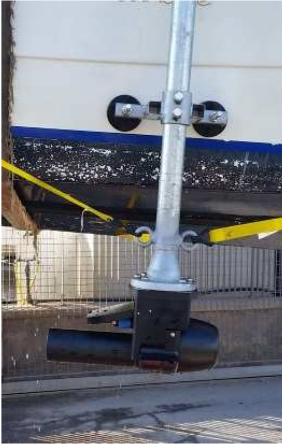
Figura 7 Trasduttore multibeam (a sinistra). Sonda per la misura del profilo di velocità del suono in acqua (a destra).
