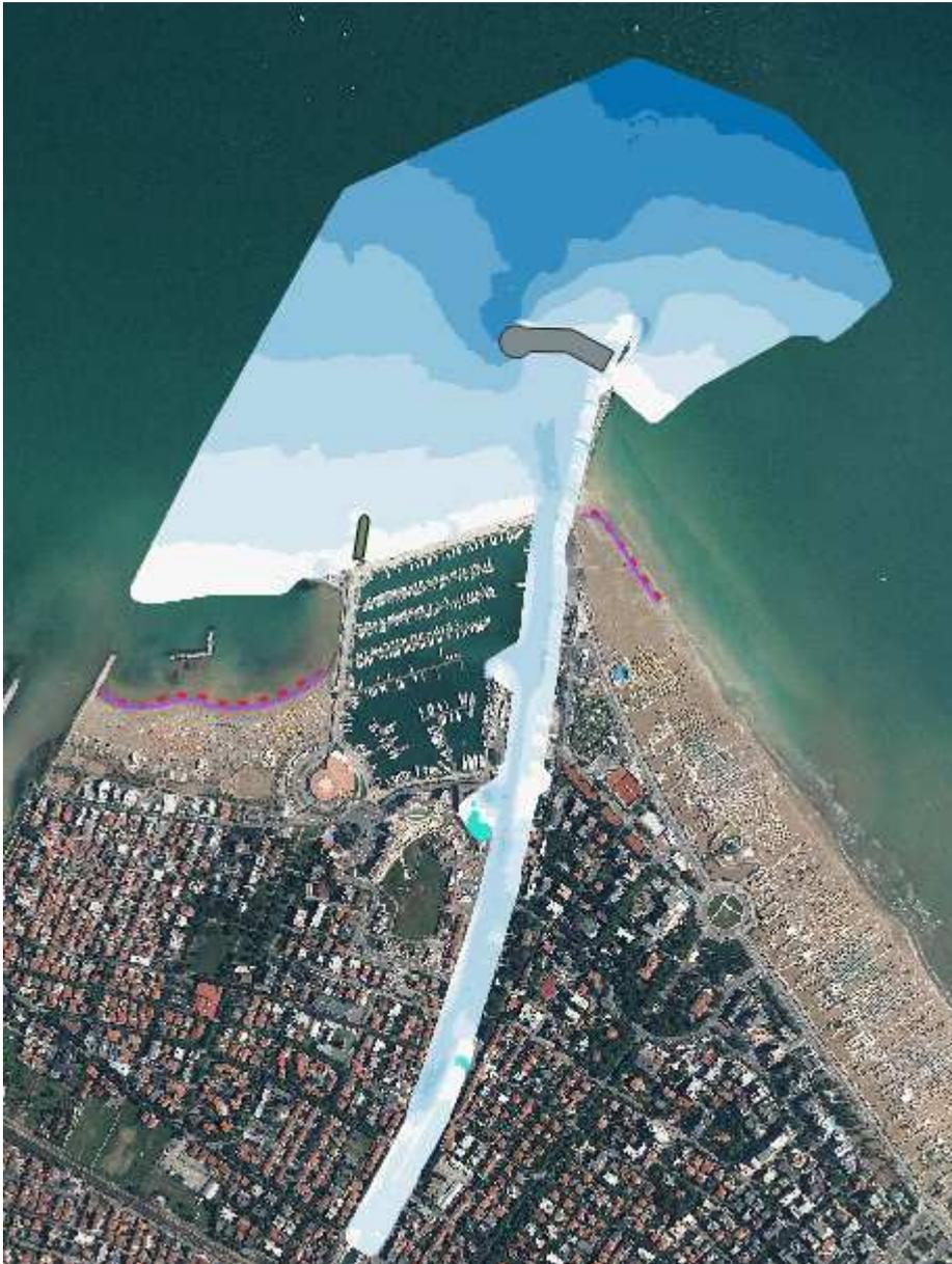
**Figura 7** Area di indagine con sistema multibeam.
