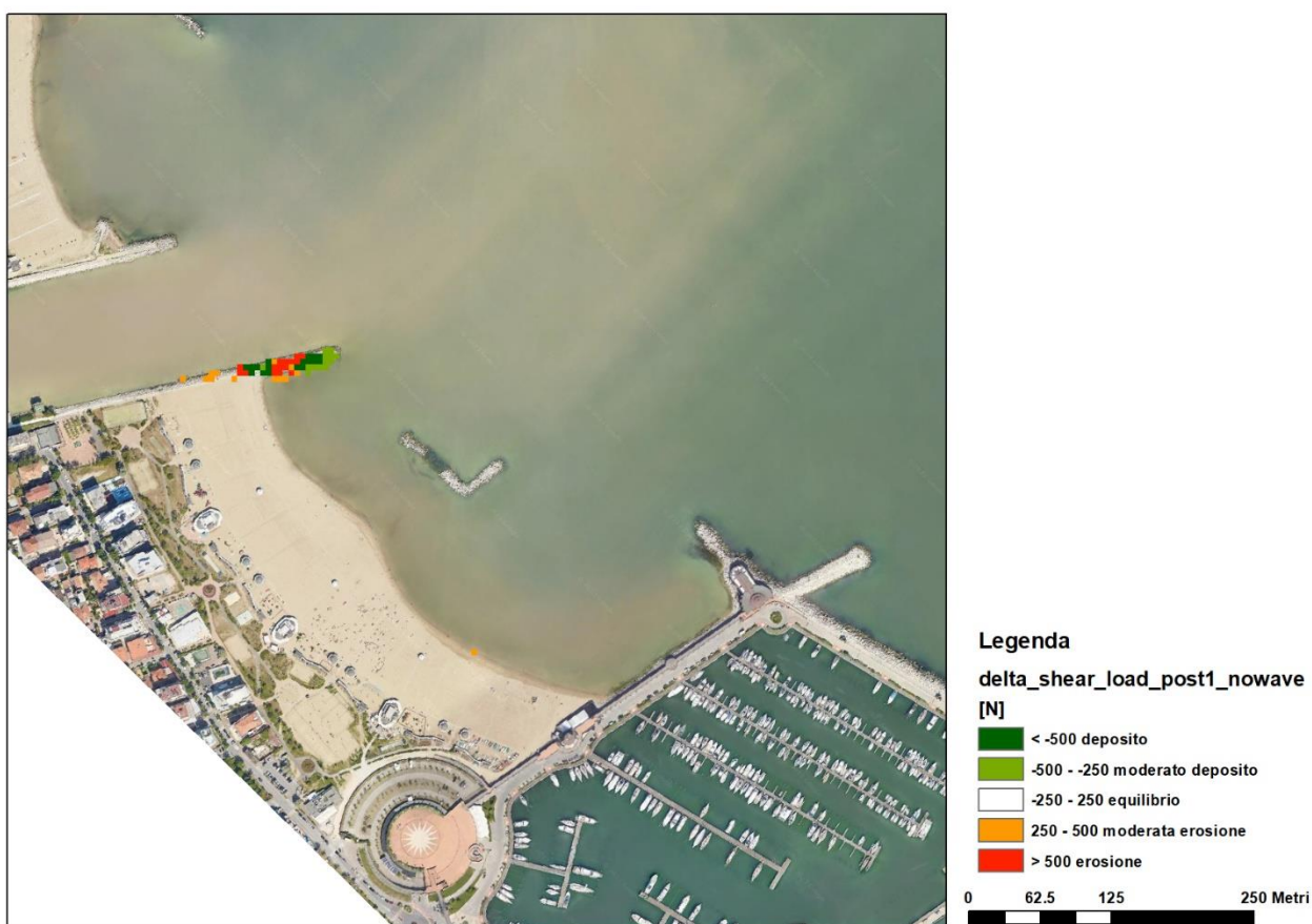
Figura 39: locali modifiche ai pattern di erosione o deposito nello scenario post-operam lotto 1
