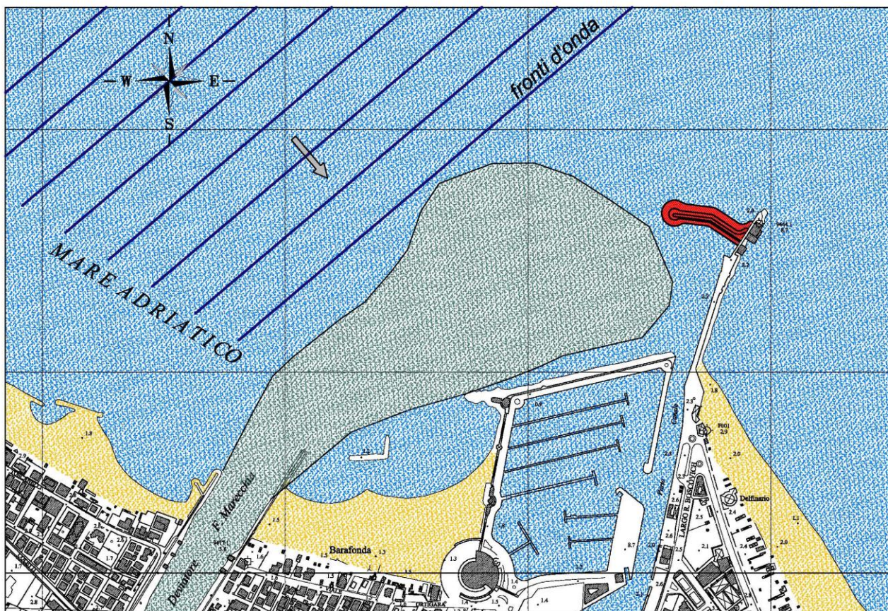
Figura 4: Deviazione del pennacchio dovuta ad una mareggiata da NordOvest (figura 7.4 di [4])
