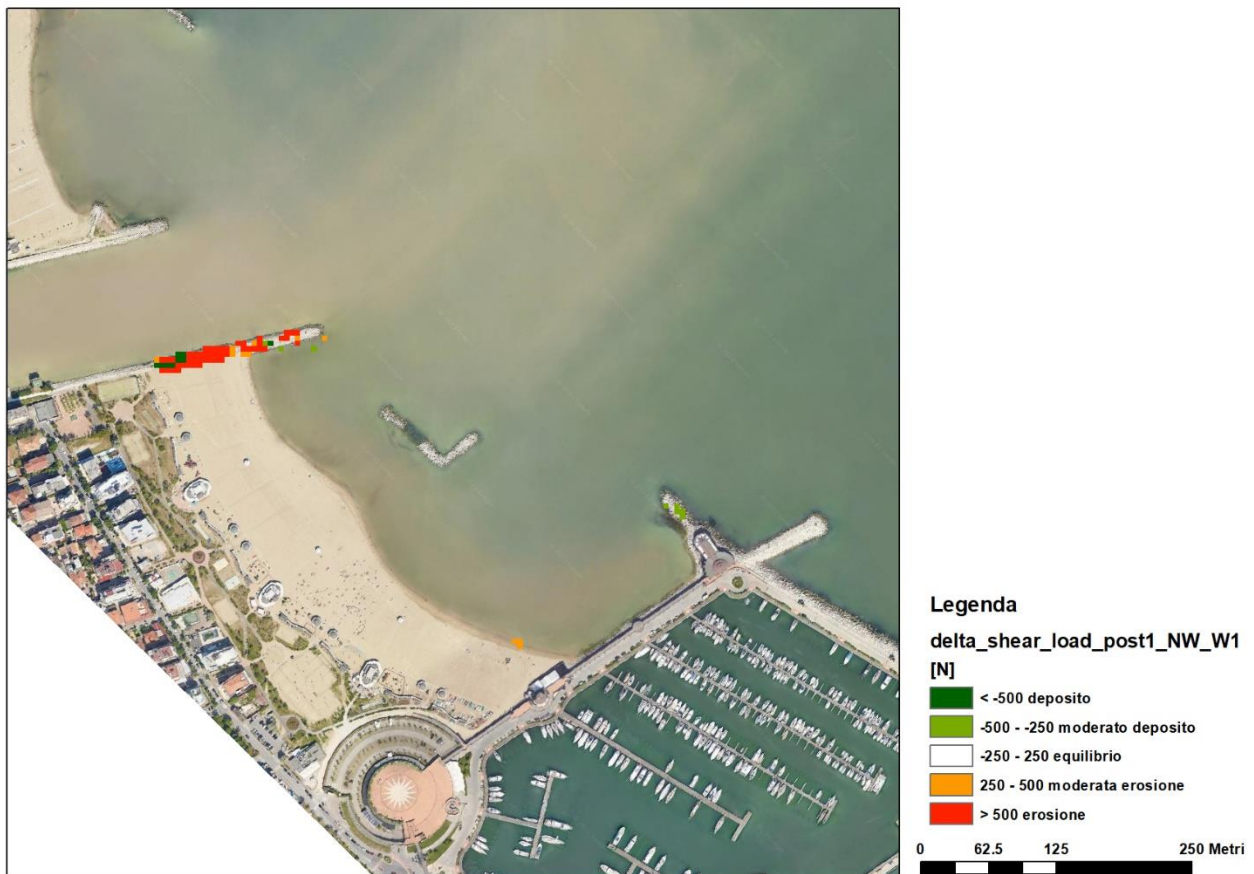
Figura 69: locali modifiche ai pattern di erosione o deposito nello scenario post-operam lotto 1
