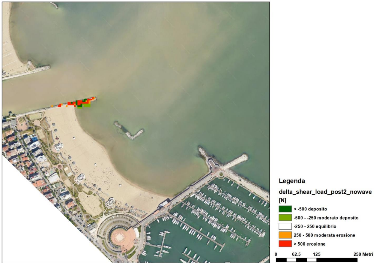
Figura 40: locali modifiche ai pattern di erosione o deposito nello scenario post-operam lotto 2
