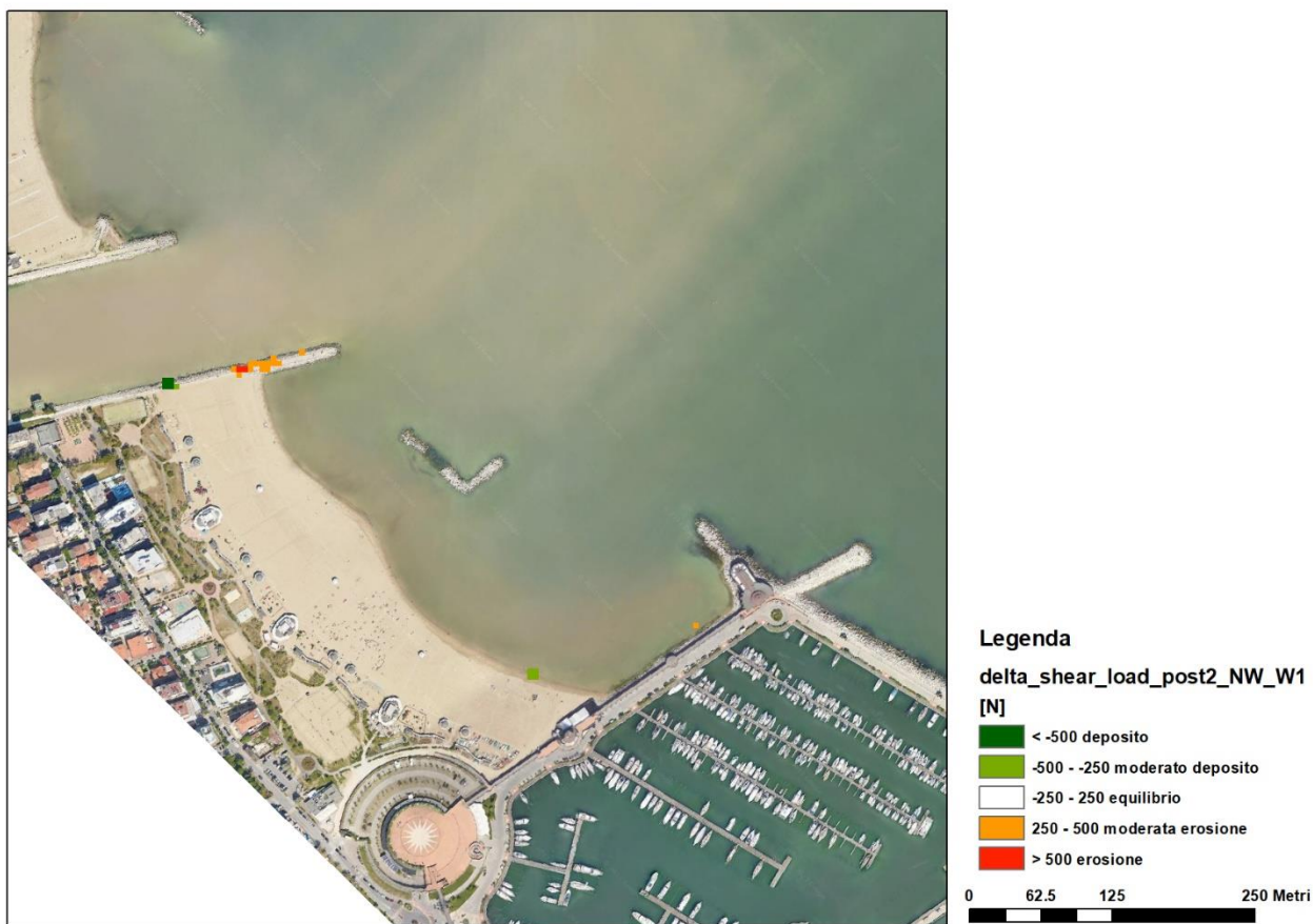
Figura 70: locali modifiche ai pattern di erosione o deposito nello scenario post-operam lotto 2
