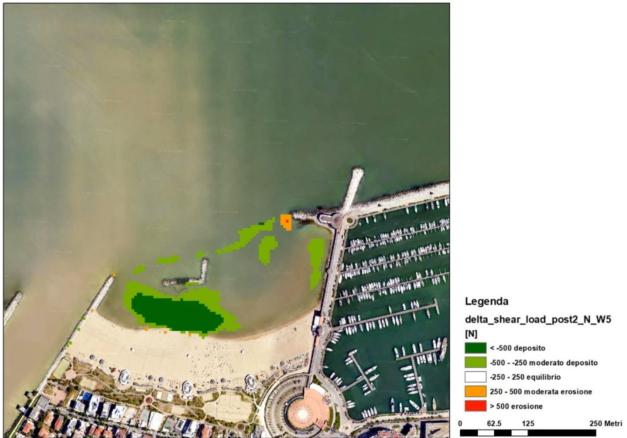
Figura 85: locali modifiche ai pattern di erosione o deposito nello scenario post-operam lotto 2
