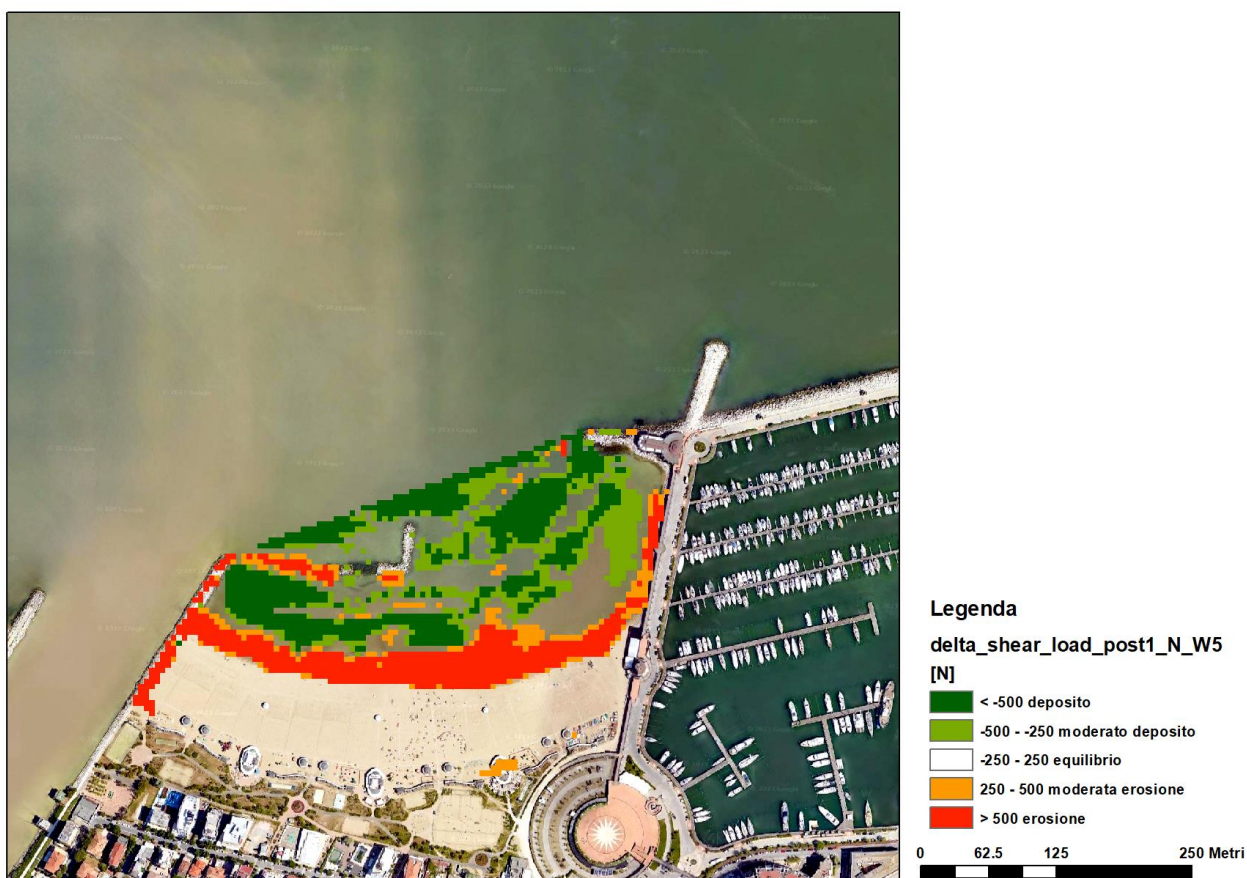
Figura 84: locali modifiche ai pattern di erosione o deposito nello scenario post-operam lotto 1
