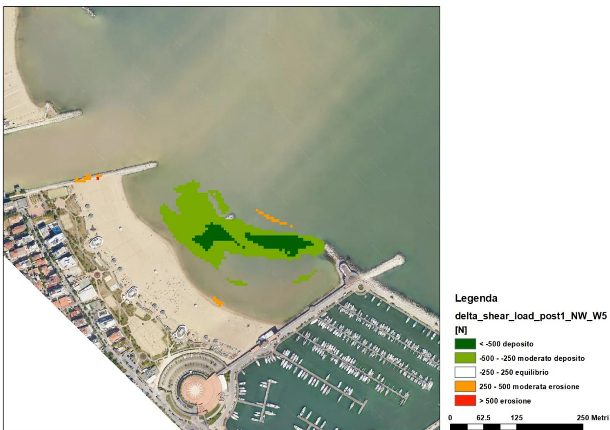
Figura 54: locali modifiche ai pattern di erosione o deposito nello scenario post-operam lotto 1
