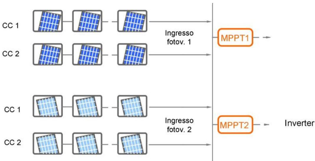
Figura 29. Rappresentazione schematica del collegamento delle stringhe fotovoltaiche ad ogni inverter
