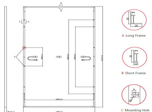
Figura 15. Scheda tecnica del modulo JW-HD120N
