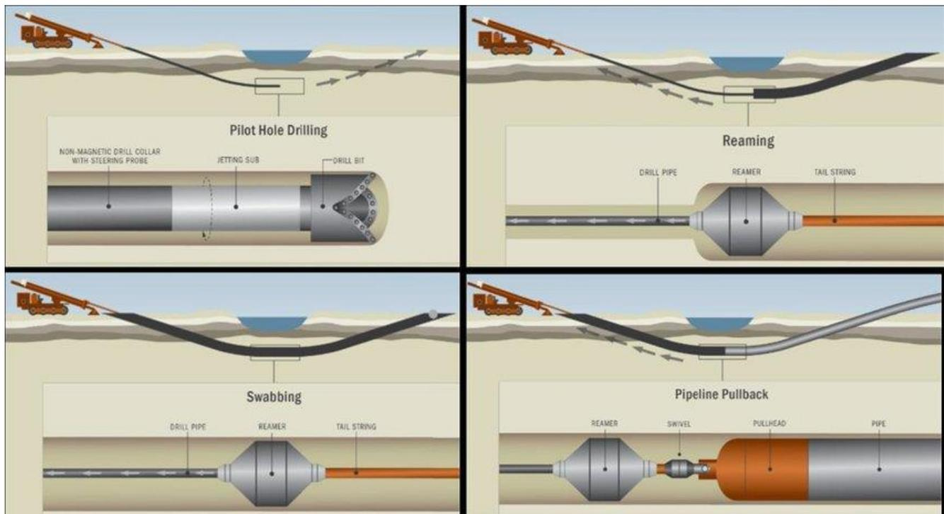
Figura 32. Esecuzione tipica di una T.O.C.
