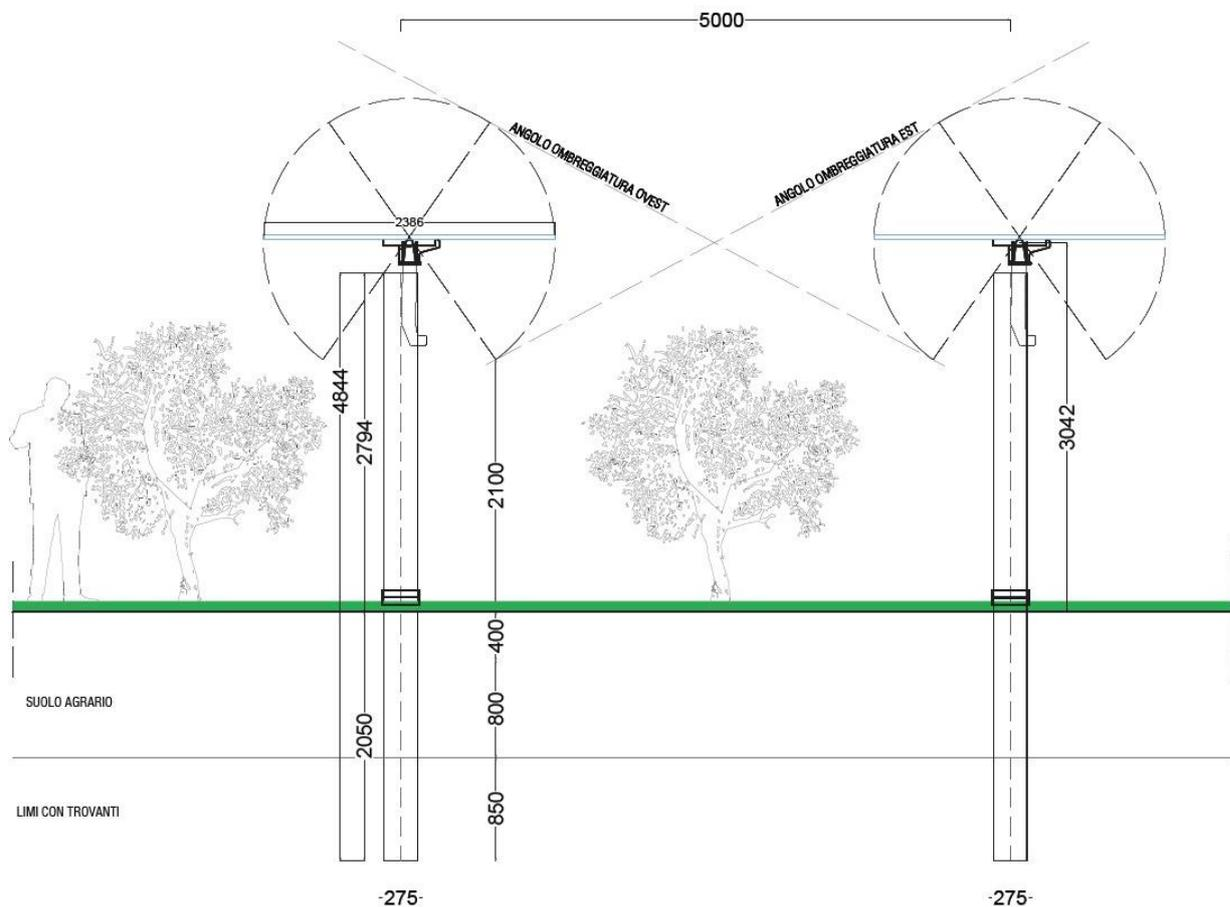
Figura 18. Sezione trasversale tracker in area ad attività colturale
