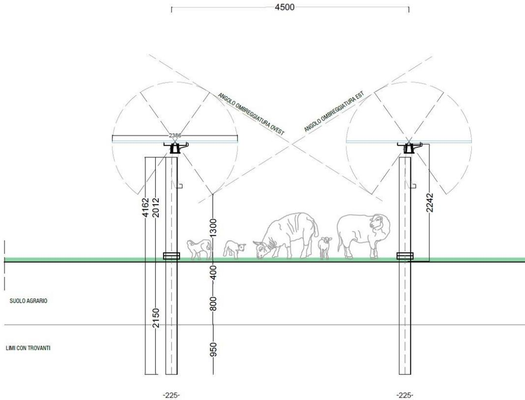
Figura 19. Sezione trasversale tracker in area ad attività zootecnica
