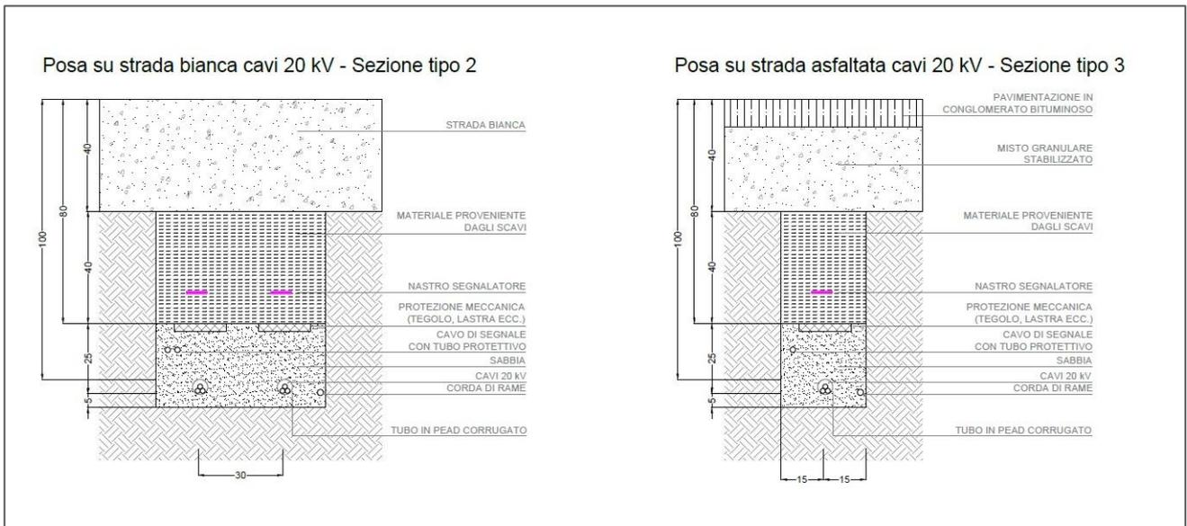
Figura 31. Esempio di tipico di scavo per posa cavidotto a 20 kV
