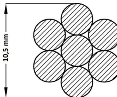
Figura 21. Fune di guardia di acciaio rivestito di alluminio  $\varnothing$  10,5 mm
