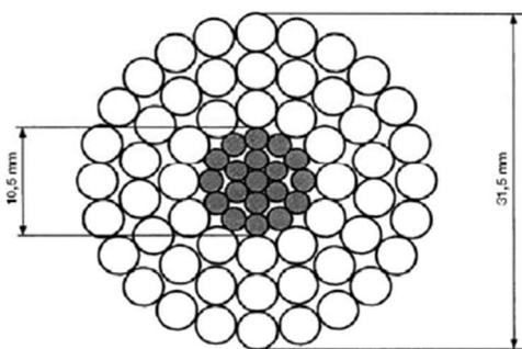
Figura 22 Conduttore a corda di alluminio-acciaio da 31,5mm.
