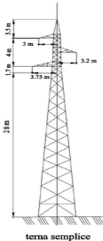
Figura 23. Traliccio di sostegno tipo N mensole per linea 150 kV semplice TERNA.
