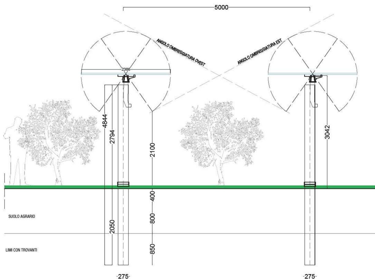
Figura 14. Sezione trasversale tracker in area ad attività colturale
