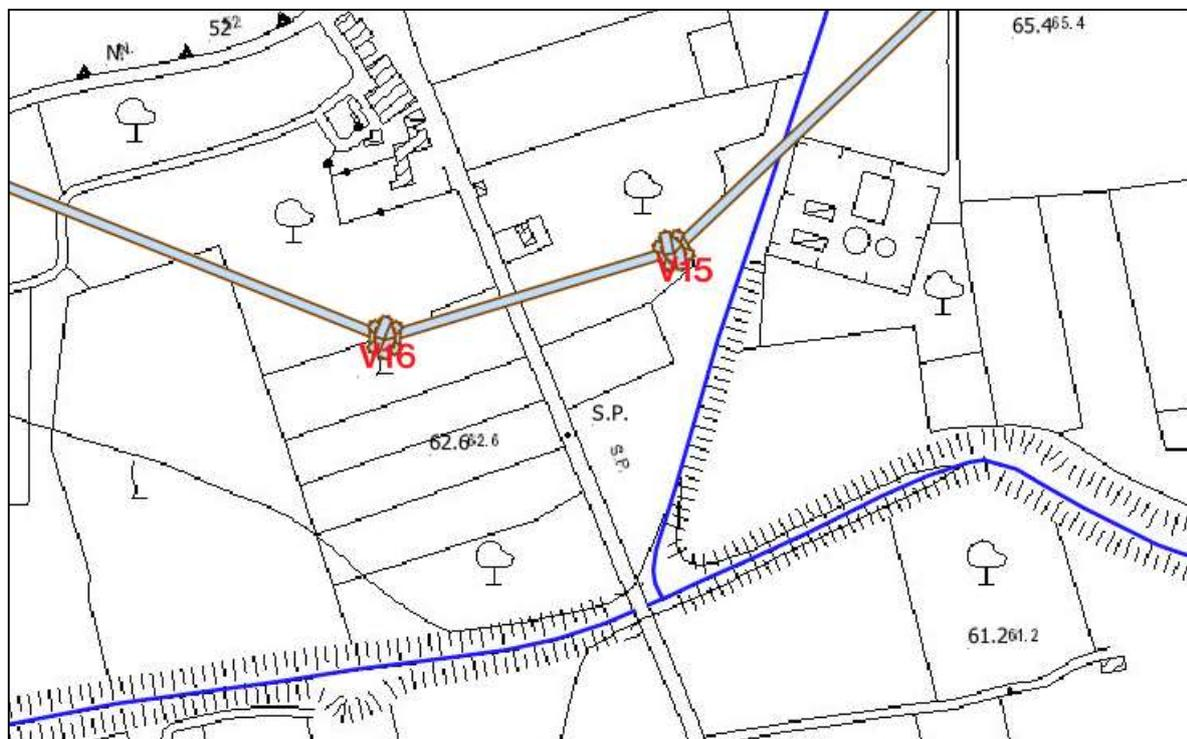
Figura 26. Particolare posizione Traliccio vertice V15 rispetto al reticolo idrografico.
