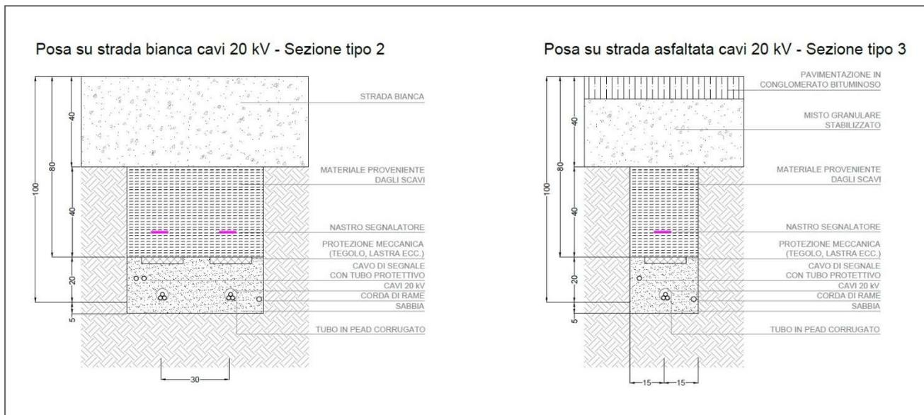
Figura 20. Esempio di tipico di scavo per posa cavidotto a 20 kV
