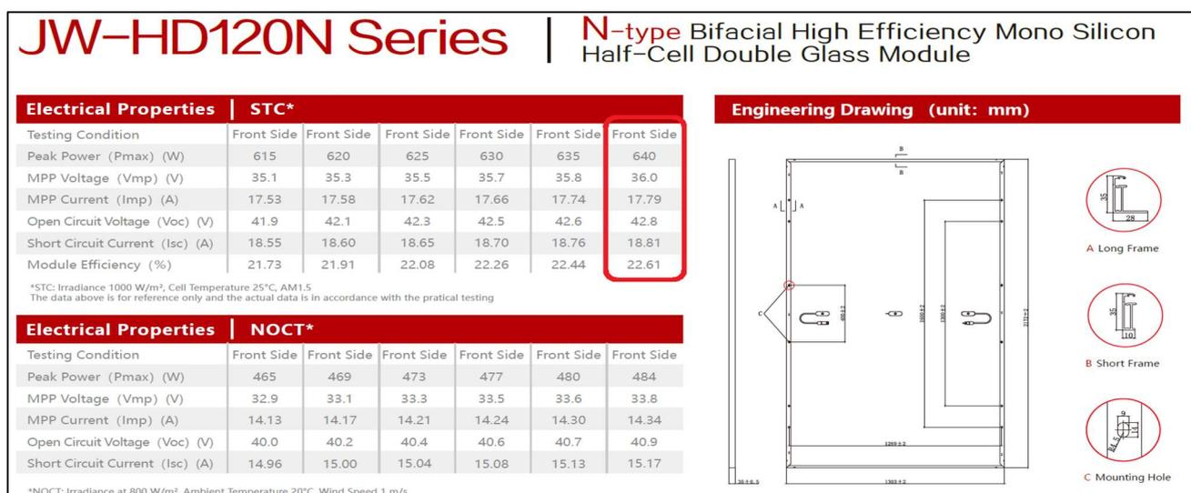
Figura 11. Scheda tecnica del modulo JW-HD120N
