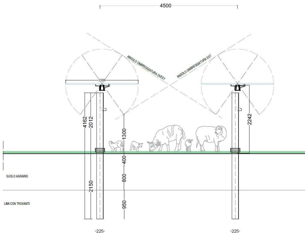
Figura 15. Sezione trasversale tracker in area ad attività zootecnica
