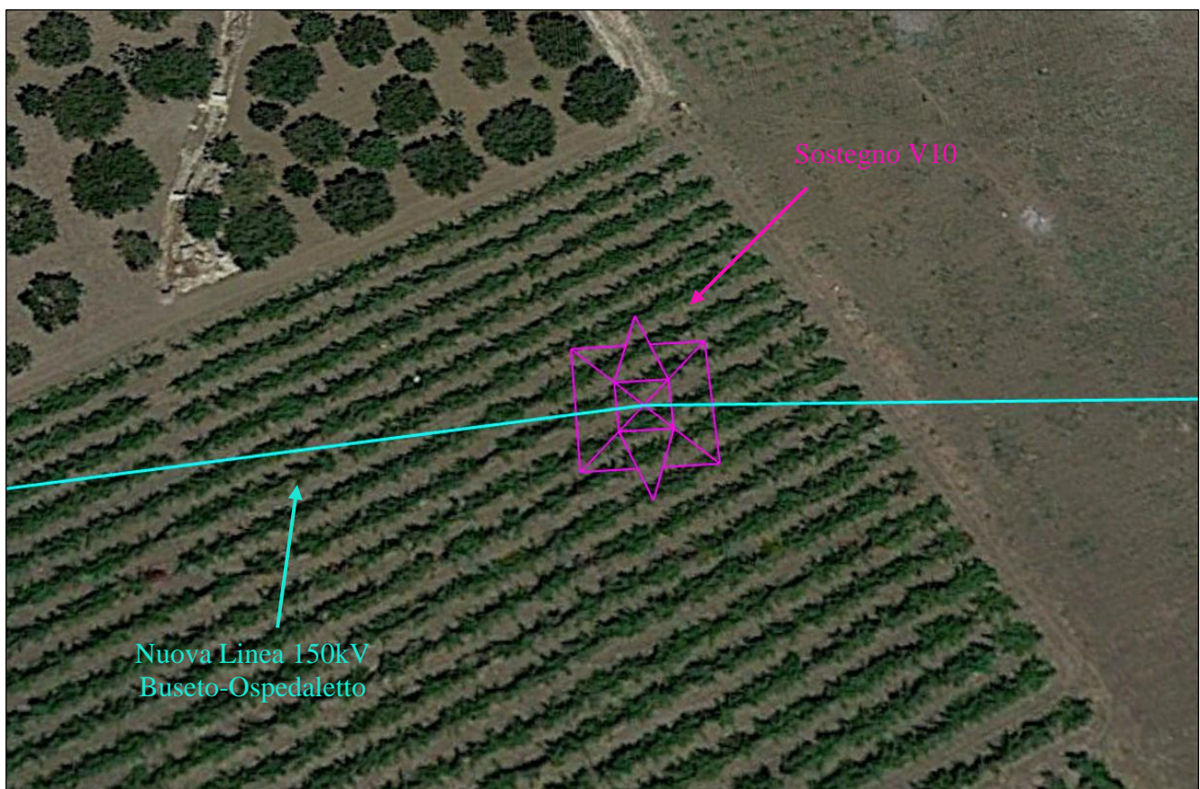
Figura 30. Traliccio vertice di sostegno V10 del nuovo elettrodotto 150kV su area a vigneto.
