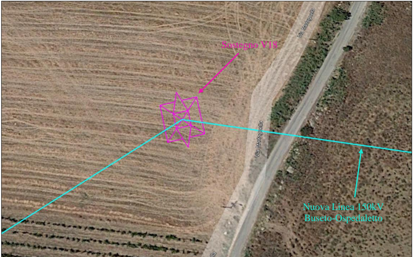
Figura 31. Traliccio vertice di sostegno V18 del nuovo elettrodotto 150kV su area a seminativo.
