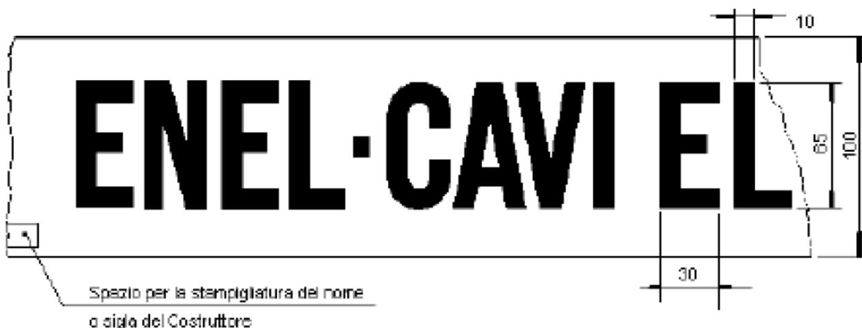
Figura 10: Esempio di nastro segnalatore cavi elettrici con caratteristiche dimensionali
