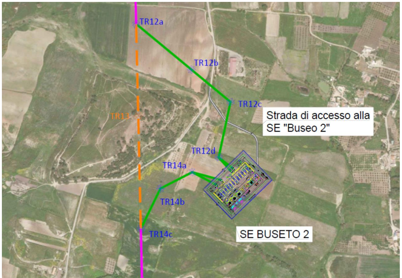
Figura 1 - Inquadramento su ortofoto della linea aerea Busetto-CP Ospedaletto (1 di 5)
