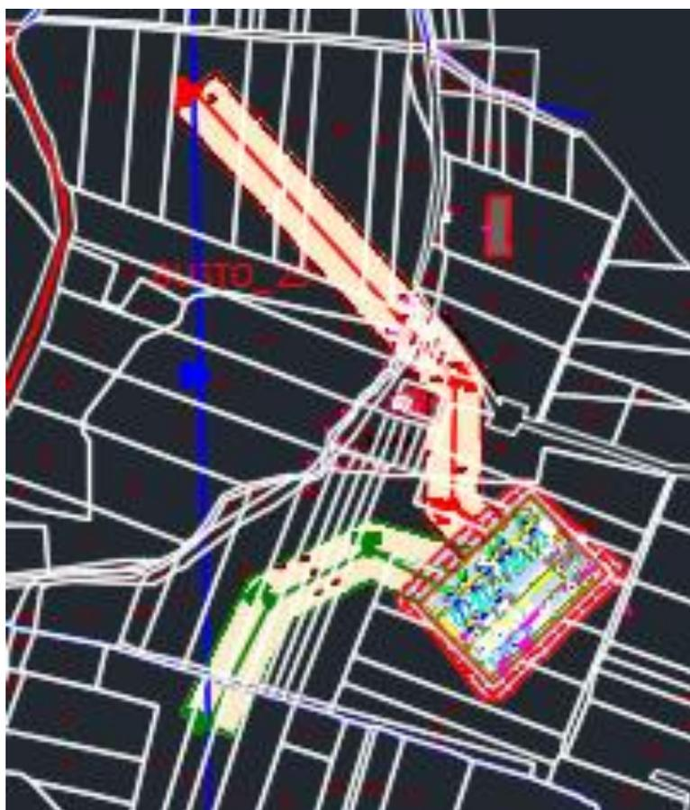
**Figura 2: Schema di connessione alla RTN della Futura SE di Buseto 2 150/36kV con doppio entra-esce della Linea 150 kV "Buseto Palizzolo-Fulgatore" e "Buseto Palizzolo-Castellammare del golfo"**
