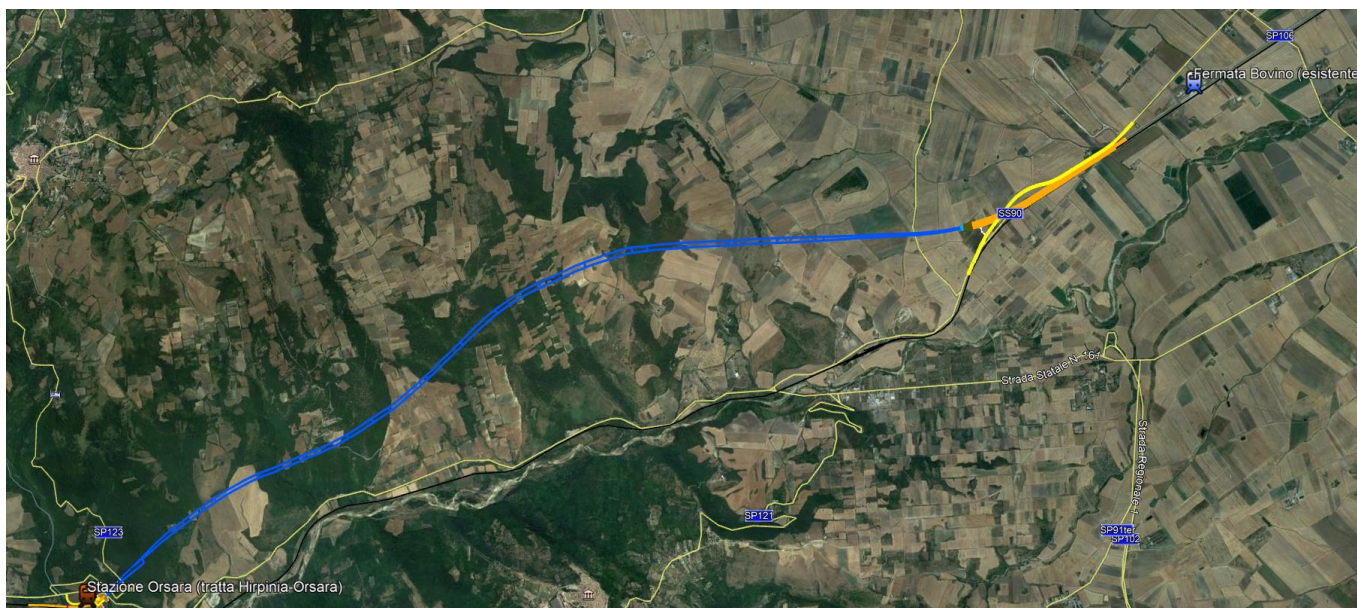
Figura 4-2. Corografia della linea. In blu la tratta in galleria, in arancio la tratta in rilevato ed in giallo le nuove viabilità
