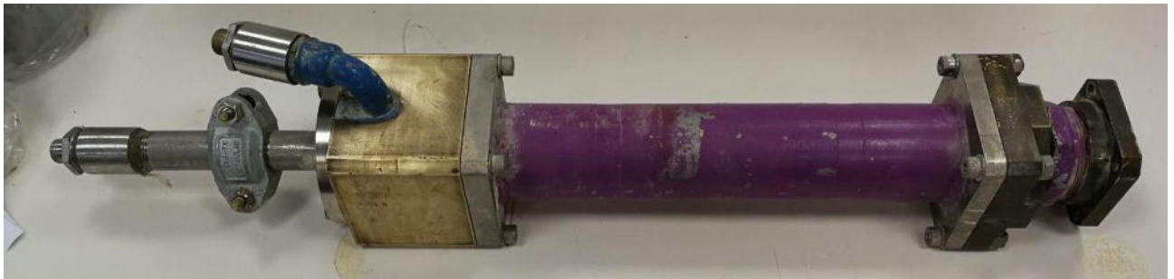
Figura 9. Lancia di generazione della schiuma disponibile presso il Dipartimento di Ingegneria Strutturale e Geotecnica (DISG) dell'Università di Roma "Sapienza" utilizzata per la sperimentazione.
