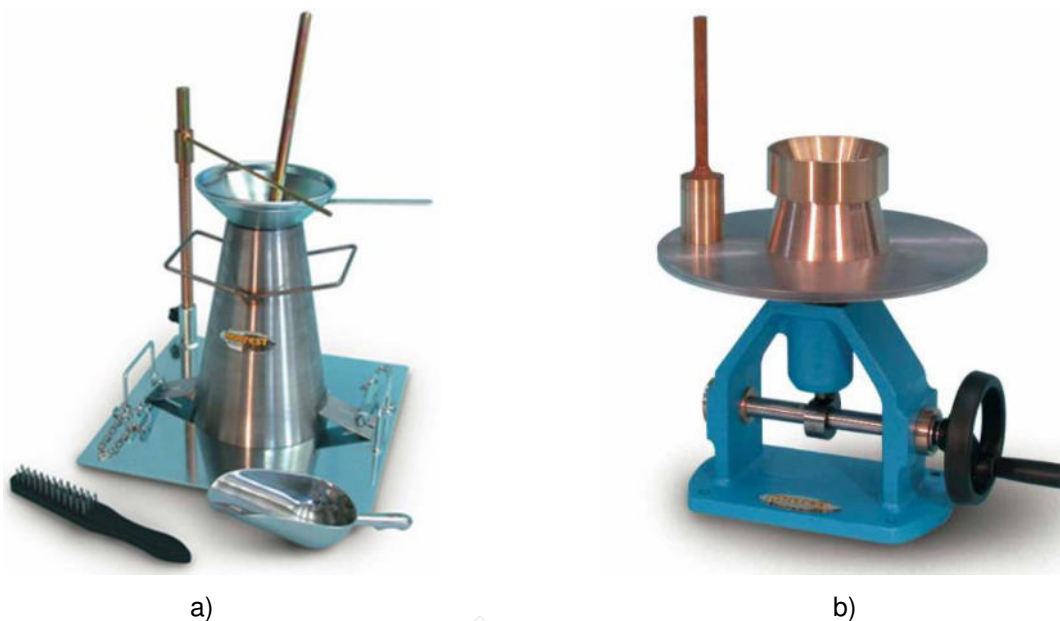
Figura 15. Cono di Abrams (a) e tavola a scosse (b).
