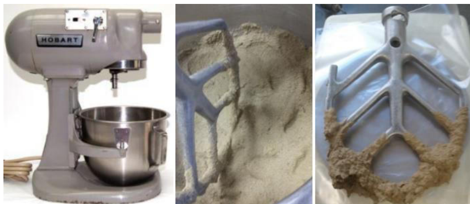
Figura 12. Attrezzatura per il mixing test.
