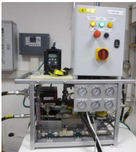
Figura 8. Generatore di schiuma messo a punto presso il Dipartimento di Ingegneria Strutturale e Geotecnica (DISG) dell'Università di Roma "La Sapienza".
