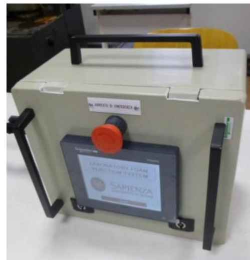
Figura 8. Generatore di schiuma messo a punto presso il Dipartimento di Ingegneria Strutturale e Geotecnica (DISG) dell'Università di Roma "La Sapienza".
