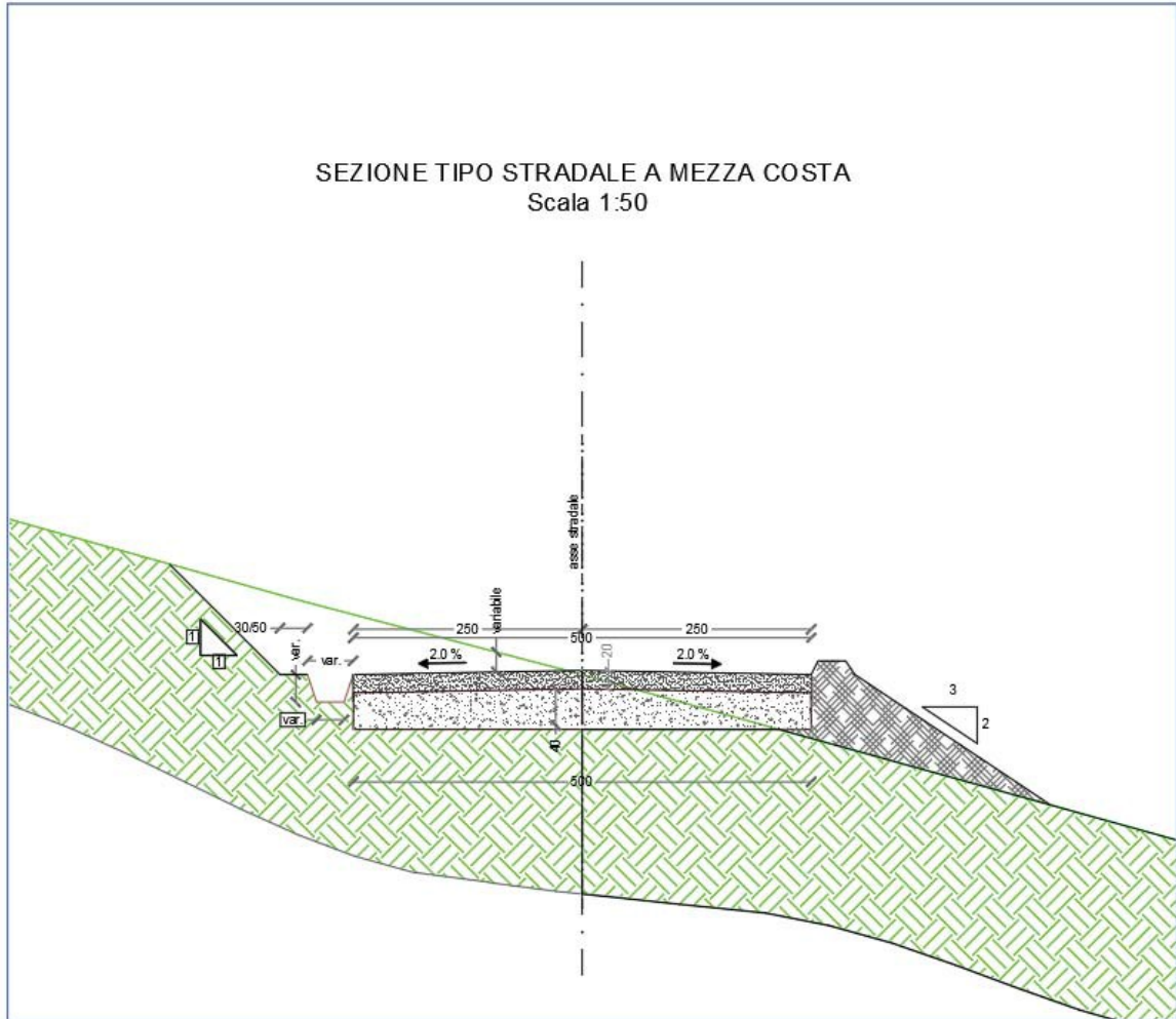
Figura 7 – Sezione tipo stradale a mezza costa
