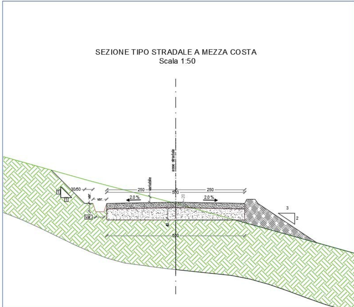
Figura 9 – Sezione tipo stradale a mezza costa
