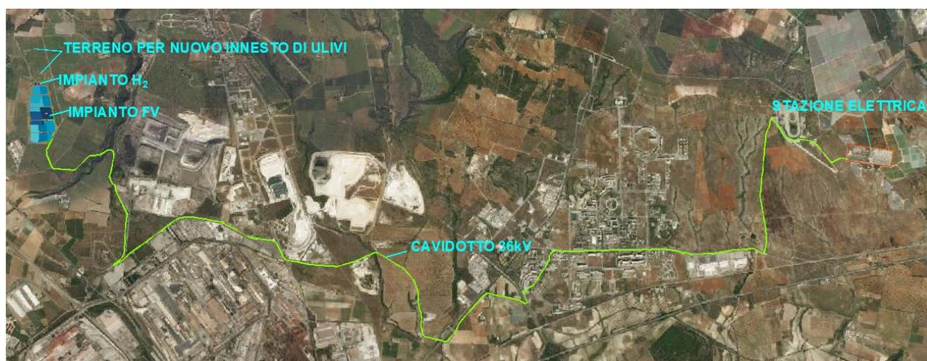
Nell'immagine satellitare, si evince l'area occupata dal Generatore Fotovoltaico (24,6 MW), l'area destinata all'impianto di produzione di idrogeno verde per n° 2 elettrolizzatori da 2,00 MW (4,00 MW totali), l'area nella disponibilità del proponente utilizzata per innesto nuovi ulivi e l'elettrodotto a 36 kV in collegamento alla Stazione Elettrica (SE) come indicato nella Soluzione Tecnica Minima Generale (STMG).
