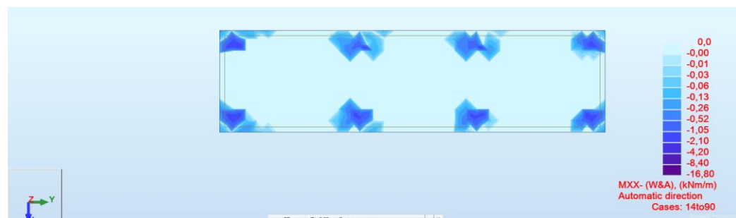
FIG. 36 – INVILUPPO INFERIORE MOMENTO FLETTENTE (WOOD&ARMER) DIREZIONE X
