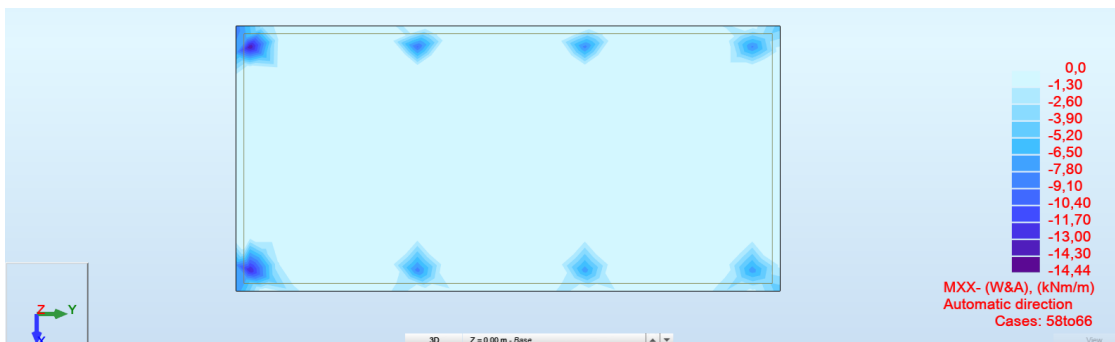
FIG. 82 – INVILUPPO INFERIORE MOMENTO FLETTENTE (WOOD&ARMER) DIREZIONE X
