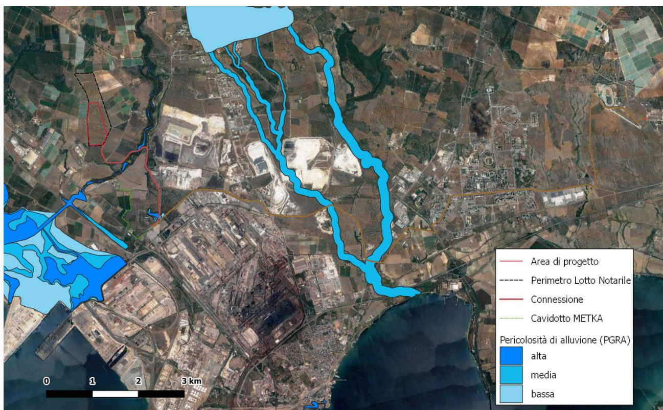
Figura 3.38. Estratto della mappa della pericolosità e del rischio di alluvioni ai sensi P.G.R.A. 2021 (area di progetto e relative opere di connessione in rosso; fonte: http://www.pcn.minambiente.it/mattm/direttiva-alluvioni/ )
