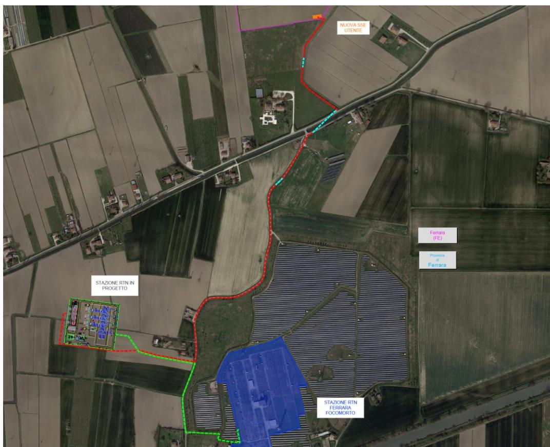
Figura 10 - Nell'immagine sopra, è rappresentata la rete di connessione AT. In rosso i tratti posati con scavo a cielo aperto, in azzurro con T.O.C.
