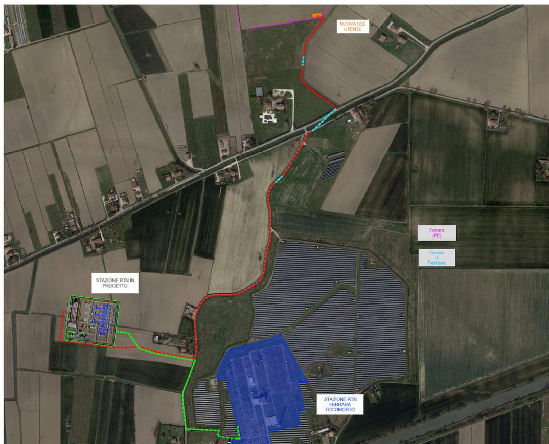
*In rosso il tracciato dell'elettrodotto di connessione alla stazione RTN in progetto, espansione della stazione RTN Focomorto. In verde l'elettrodotto interrato di collegamento fra le due. In azzurro i tratti in T.O.C.*
