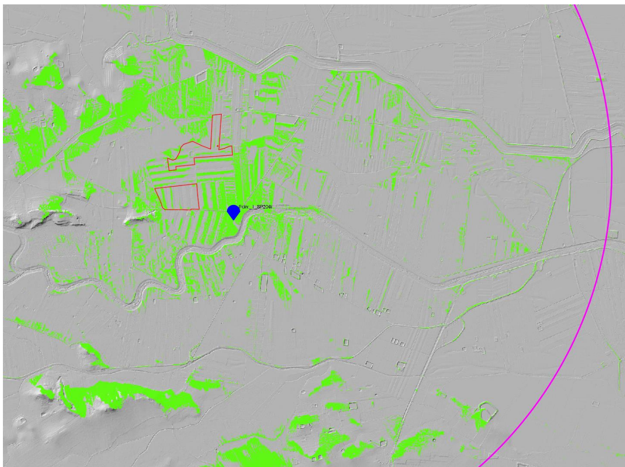
Figura 23 – Carta intervisibilità Punto 1_ In rosso l'area di progetto, in verde le aree visibili.
