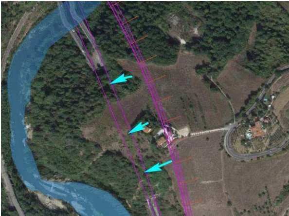
Figura 13 – Indicazione su planimetria dei punti in cui si sono riscontrate tracce di infiltrazione nella galleria Bruschetto esistente.
