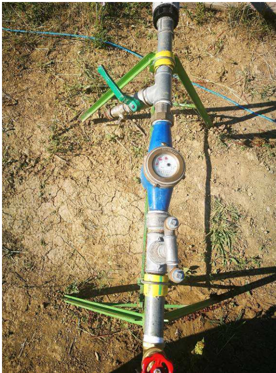
Figura 35 – Dettaglio del contatore per la misura della portata (immagine a sinistra); nell'immagine a destra è riconoscibile il tubo di allontanamento delle acque emunte che confluisce in un'incisione.
