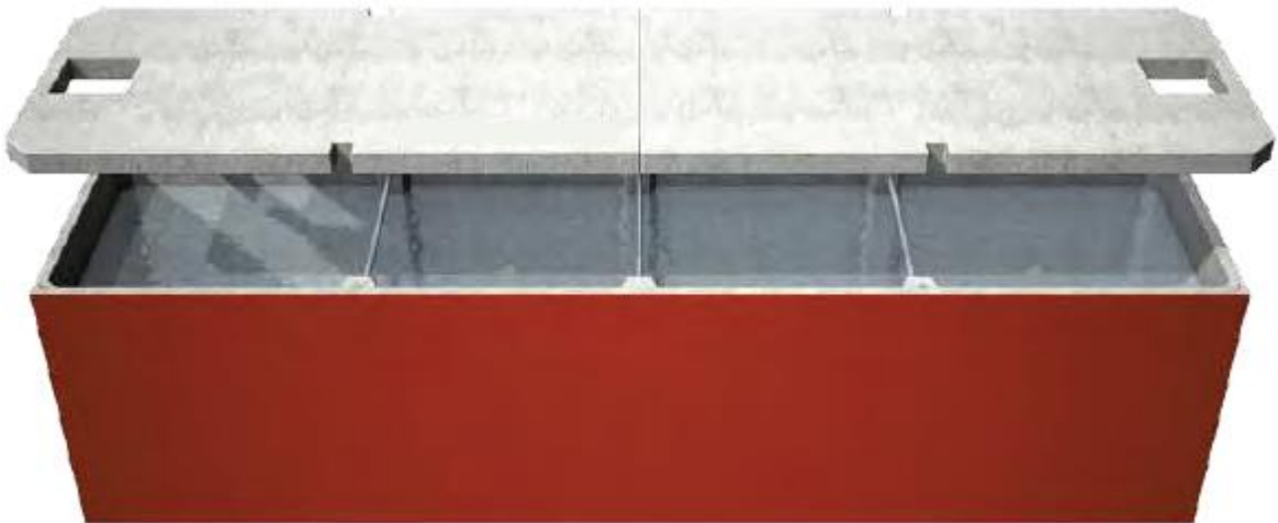
Figura 3-8: Rappresentazione di una vasca di accumulo prefabbricata monoblocco
