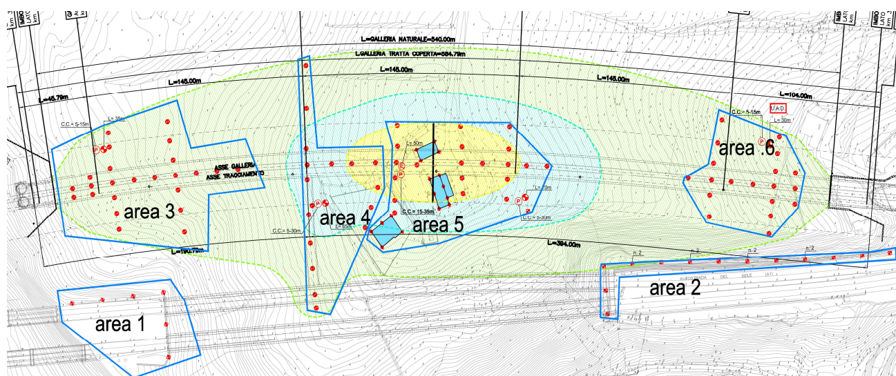
Figura 1: Siti di monitoraggio topografico per controllo subsidenza
