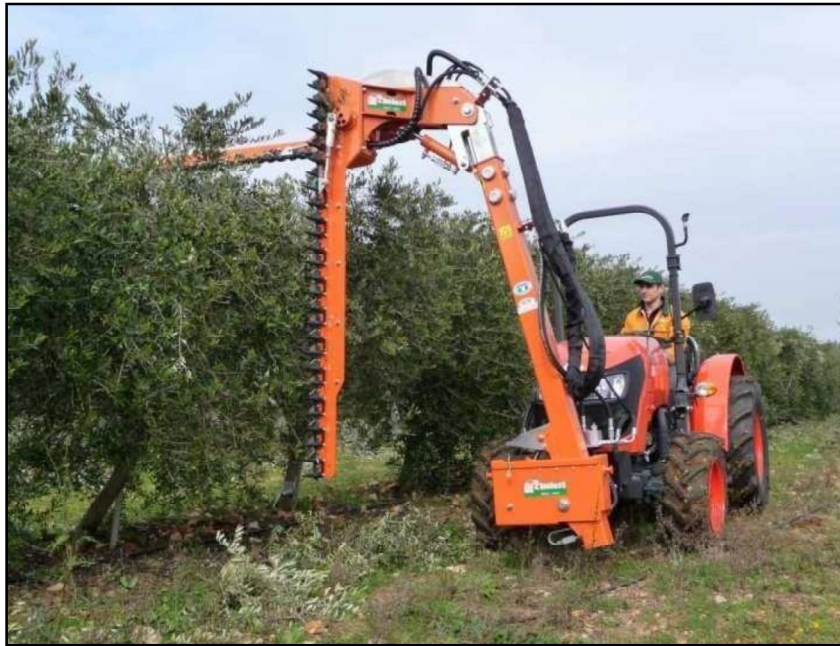
Esempio di potatrice meccanica frontale a doppia barra (taglio verticale + topping) utilizzabile su tutti le colture arboree intensive e superintensive
