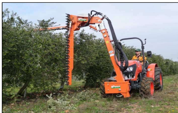
Figura 14- Esempio di potatrice meccanica frontale a doppia barra (taglio verticale + topping) utilizzabile su tutti le colture arboree intensive e superintensive
