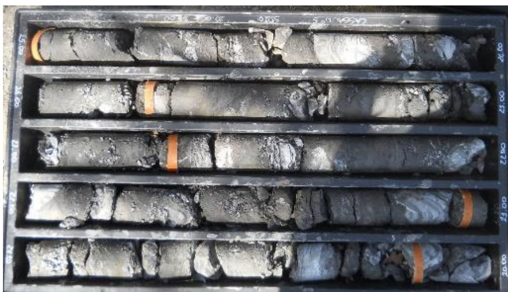
Foto 6 – Sondaggio SD20 – Aspetto delle argilliti ed arenarie attribuite ad AGA
