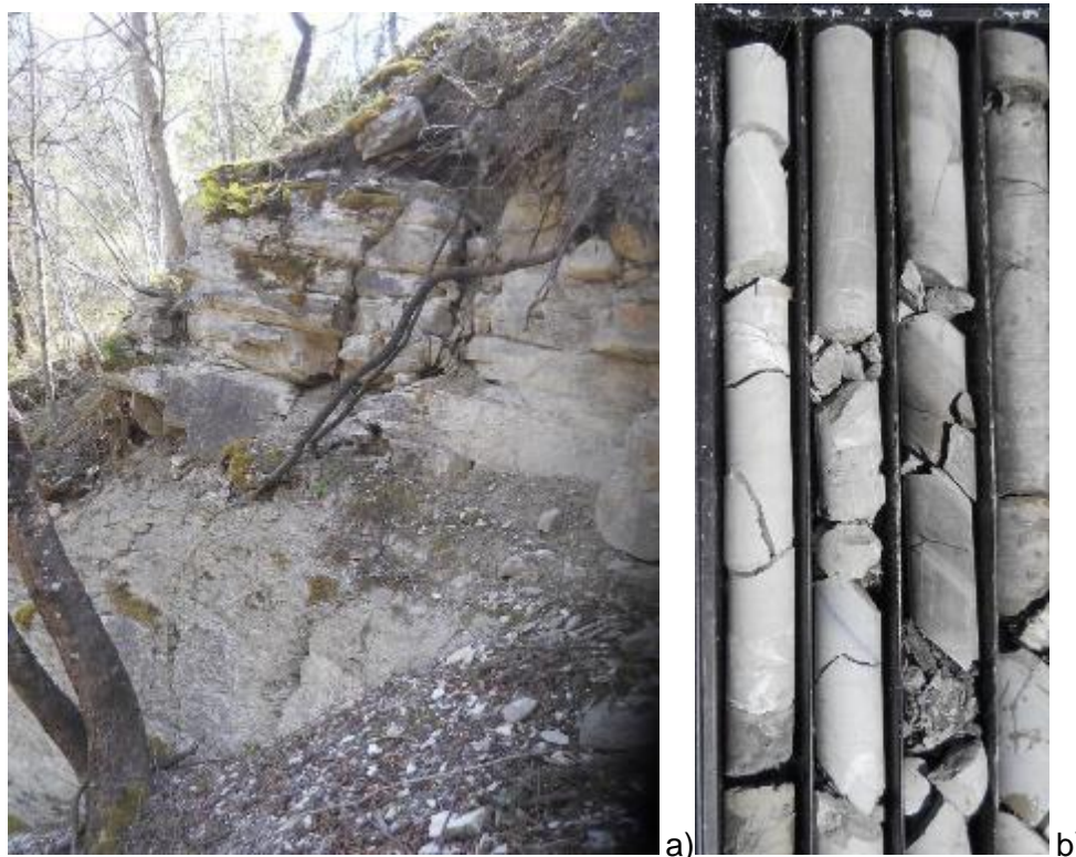
Foto 4a,b – Formazione di Monte Morello-MLL a) affioramento: nella parte alta si riconoscono i livelli calcarei e calcareo-marnosi, in basso le marne. b) aspetto di MLL in sondaggio (SD4bis). I colori più chiari caratterizzano i calcari e quelli lievemente più scuri le porzioni marnose.
