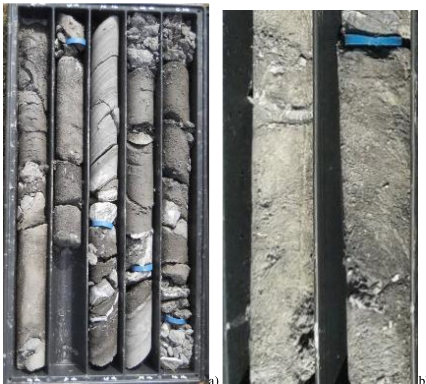
Foto 5a,b – Formazione di Sillano (SIL) – Sondaggio SD4. a) si riconoscono i livelli litoidi talora presenti nelle argilliti. b) particolare delle argilliti con clivaggio riconoscibile
