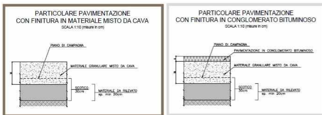
Figura 2-21 Particolare pavimentazione aree di cantiere (da CAP200)
