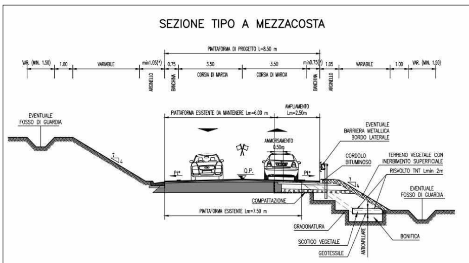
Figura 2-9. Sezione tipo a mezza costa ampliamento Cavet
