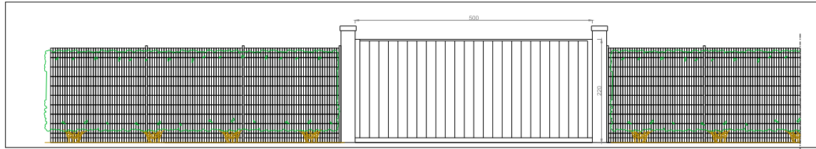
CANCELLO SCORREVOLE D'ACCESSO ALL'IMPIANTO - PROSPETTO - Scala 1:50
