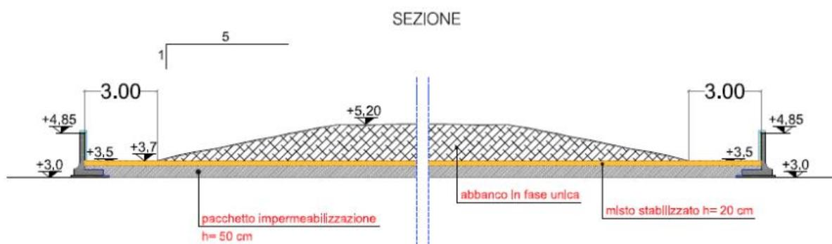
Figura 7 Schema tipologica vasche a tenuta di deposito temporaneo
