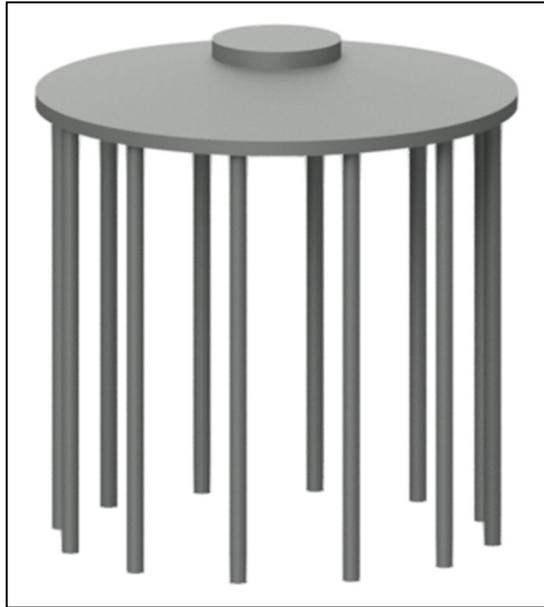
Figura 9: Vista tridimensionale della fondazione dell'aerogeneratore.
