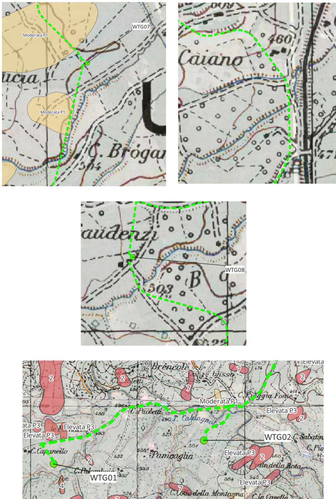
Figura 21 – Punti di attraversamento in TOC del cavidotto
