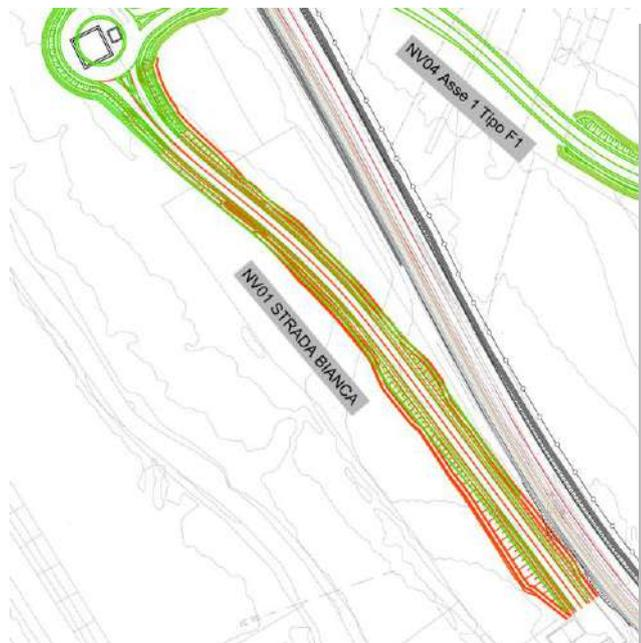
Figura 3 Ottimizzazione in termini di sezione trasversale della NV01 (in rosso il tracciato del PFTE in verde il tracciato ottimizzato)
