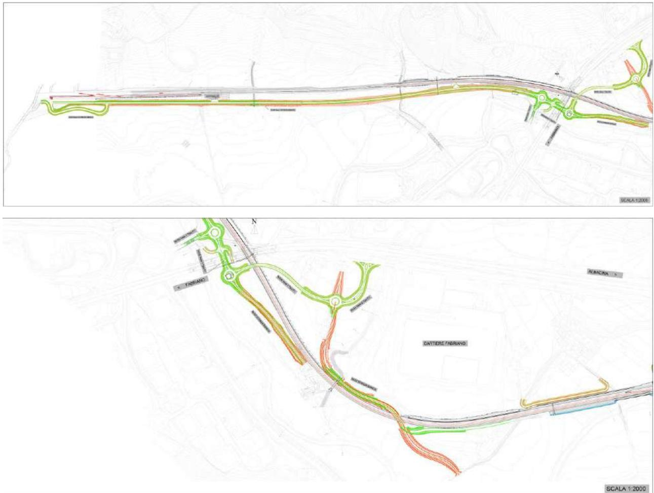
Figura 13 Sovrapposizione del progetto PFTE (in rosso) con le ottimizzazioni apportate alla viabilità (in verde) nel PFTE per gara.
