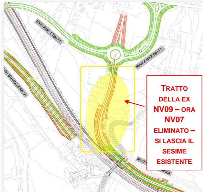
Figura 5 - Tratto iniziale NV07 (ex NV09) in rosso (nel riquadro giallo) viene eliminato e rimane solo il sedime esistente.
