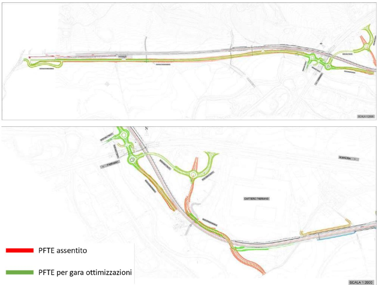
Figura 11 Sovrapposizione del progetto PFTE (in rosso) con le ottimizzazioni apportate alla viabilità (in verde).
