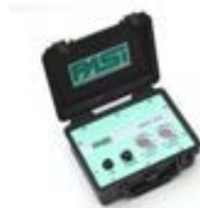
Figura 2. Acquisitore e scheda tecnica relativa per l'acquisizione HVSR
