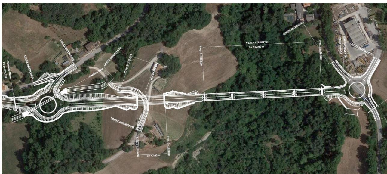
Seconda parte dell'intervento in variante, tra le due rotonde in progetto, in cui è prevista la realizzazione di una galleria artificiale di 47 m e di un viadotto di 192 m.
