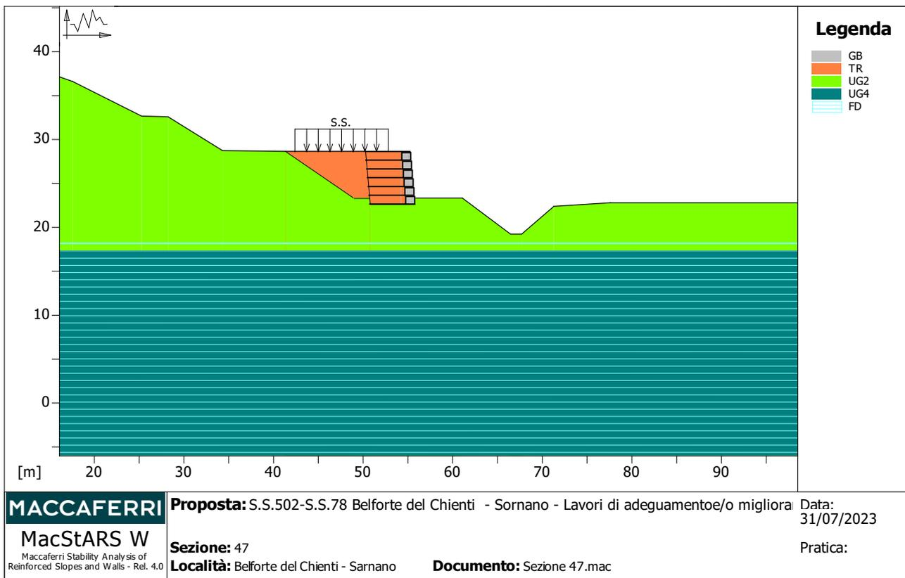
**Terreno : GB** Descrizione : Materiale di riempimento del paramento in gabbioni
