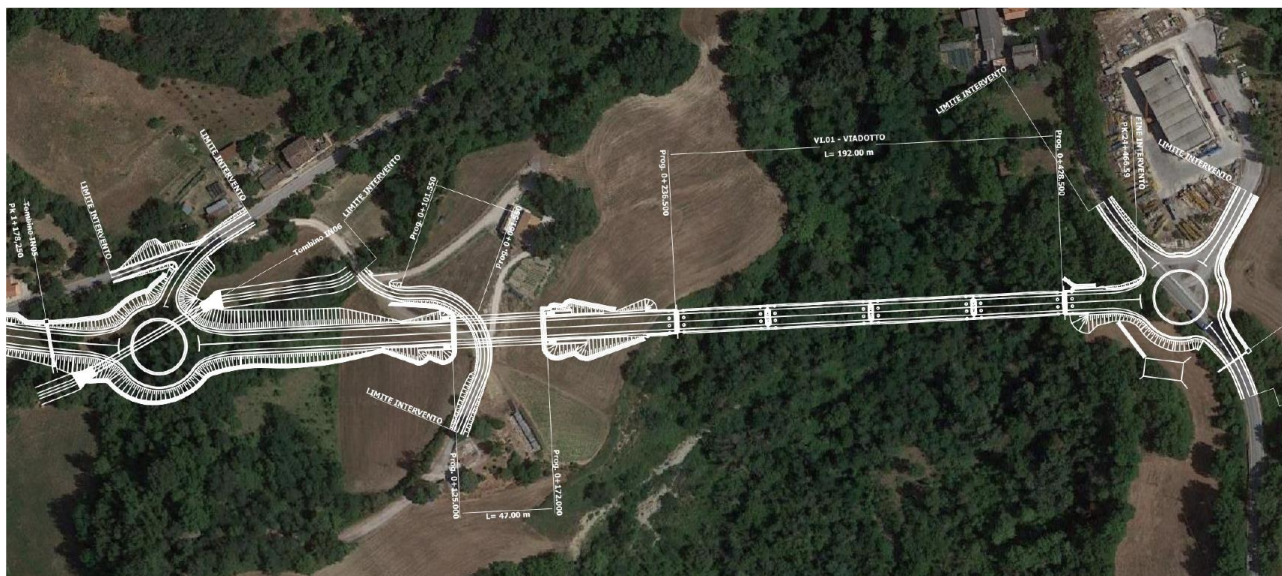
Figura 7 – Seconda parte dell’intervento in variante, tra le due rotatorie in progetto, in cui è prevista la realizzazione di una galleria artificiale di 47 m e di un viadotto di 192 m.
