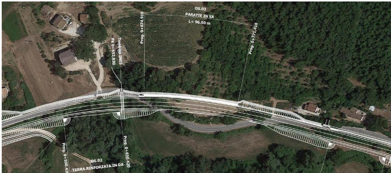
Figura 21 – Prima parte del tracciato – primo tratto che si discosta brevemente dalla sede, che prevede la realizzazione di una paratia tra la progr. 0+674 e la progr. 0+771
