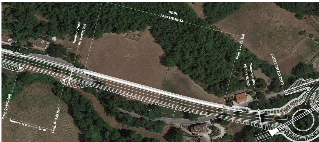
Figura 22 – Prima parte del tracciato – secondo tratto primo tratto che si discosta brevemente dalla sede, che prevede la realizzazione di di un muro a valle tra progr. 0+870 e la progr. 0+930 e una paratia tra la progr. 0+950 e la progr. 1+129.
