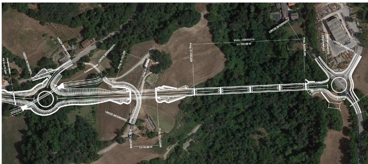
Figura 23 – Seconda parte dell’intervento in variante, tra le due rotatorie in progetto, in cui è prevista la realizzazione di una galleria artificiale di 47 m e di un viadotto di 192 m.
