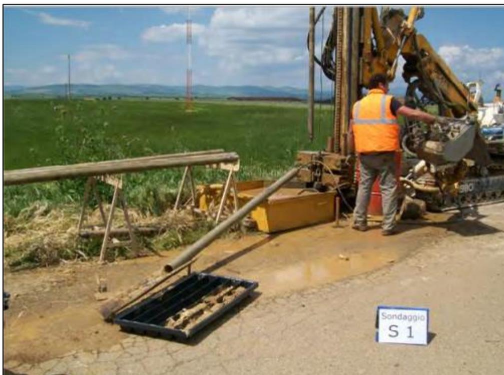
La stratigrafia mostra la presenza di litologie prevalentemente conglomeratiche alternate a sabbie rossastre e giallastre con ghiaie fino a 30 metri con un intervallo limoso-sabbioso da 21.30 a 26.00 metri di profondità.
