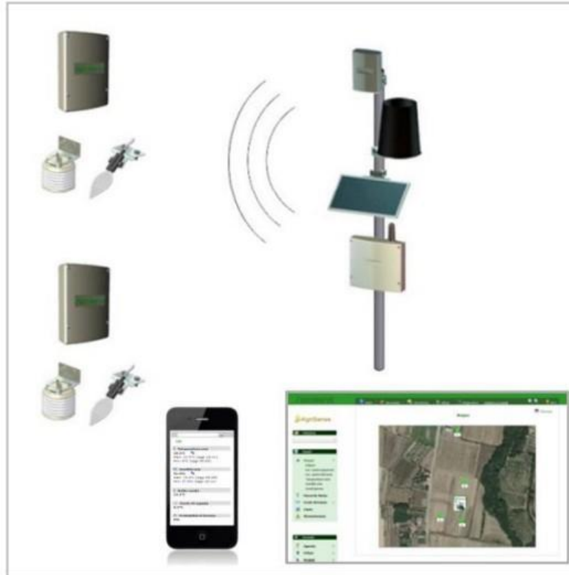
Figura 19: Stazione principale e sensori meteo climatici
